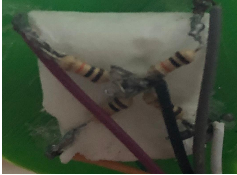
Şekil 5.7. Prototipte kullanılan 10 kΩ direnç
