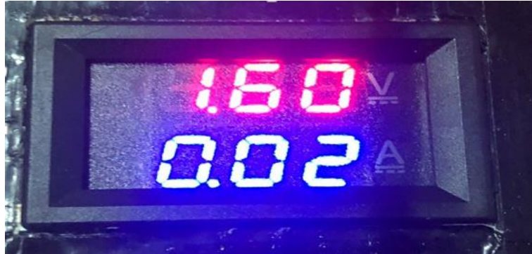
Şekil 5.8. Prototipte kullanılan dual dijital volt-ampermetre
