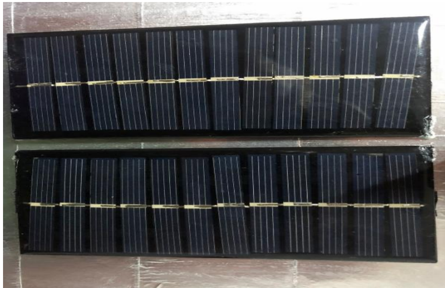
Şekil 5.3. Prototipte kullanılan 6 volt 1watt güneş panelleri
