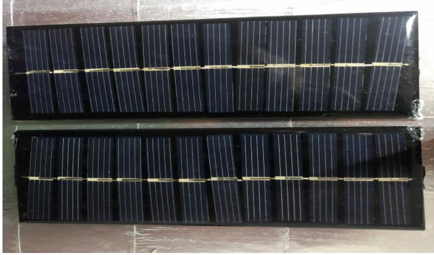
Şekil 5.18. Pleksi tabla üzerinde güneş panelleri
