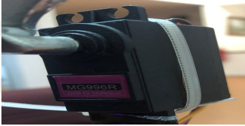
Şekil 5.4. Prototipte kullanılan MG996R servo motor
