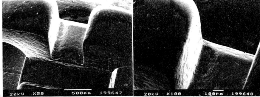
Resim 2.3. Sinterleme tekniğiyle üretilen braketin SEM görüntüleri. Oluk kenarlarındaki bitiş düzgün gözlenmektedir. Tosun'dan (30) alınmıştır.
