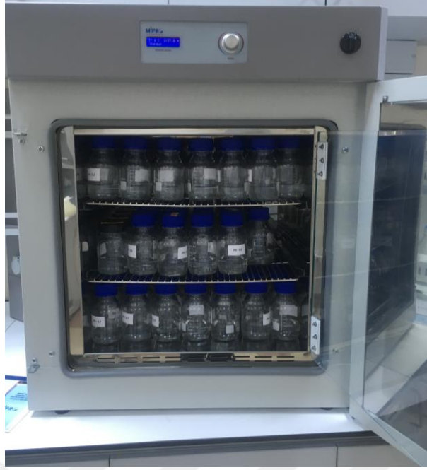
Resim 3.1. Numunelerin 37 0 C’de kapalı ortamda bekletildiği inkübatör.
