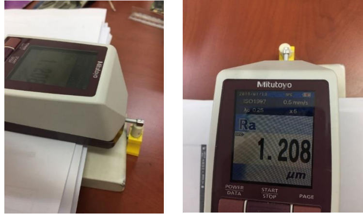
Şekil 3.2. Profilometre ile Yüzey Pürüzlülük Ölçümlerinin Yapılması
