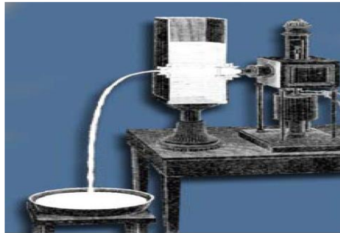
Şekil 2.6: Işığın su sütunu içerisindeki yansıması (Industrial Fiber Optics, 2008).
