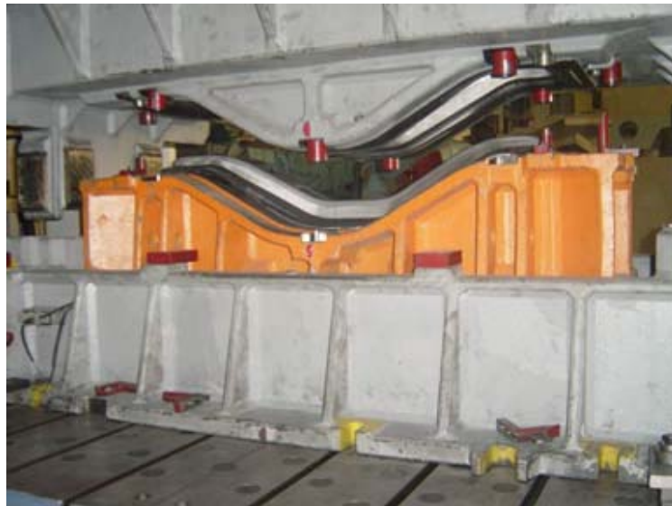
Şekil 5.2. Motor bağlama traversi üst parçasını üreten tek tesirli çekme kalıbı
