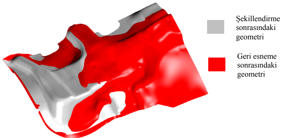
Şekil 2.14. Şekillendirme ve geri esneme sonrasındaki parça geometrisi
