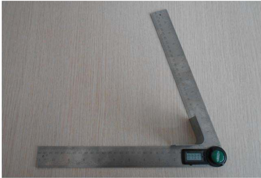
Şekil 3.8. Dijital açı ölçer yardımıyla açı ölçümünün yapılması
