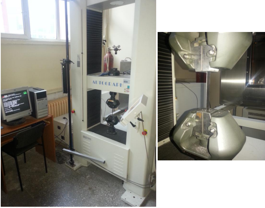
Şekil 3.1. Çekme test cihazı
