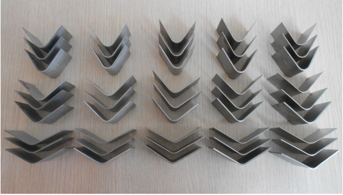
Şekil 4.1. Bükme işlemi uygulanan deney numuneleri
