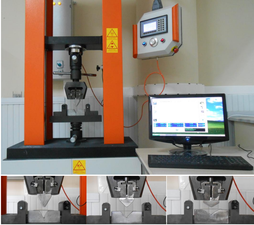
Şekil 3.6. Bükme deneyi düzeneği
