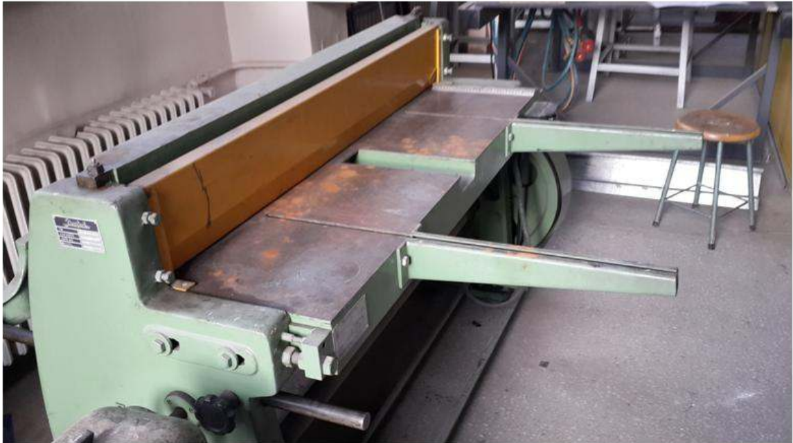
Şekil 3.5. Çelik sac malzemelerin kesme işleminde kullanılan giyotin makas
