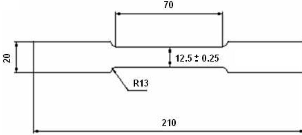
Şekil.4.1. Çekme Testi Deney Numunesi (ASTM E8 )
