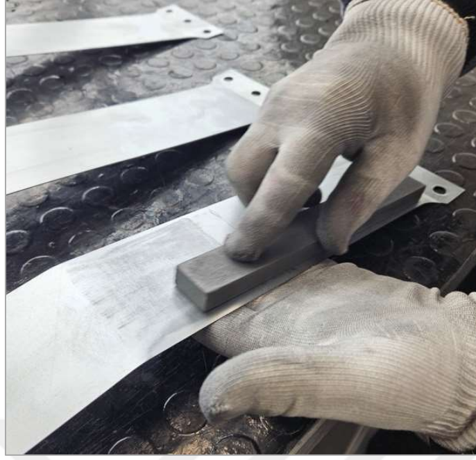
Şekil 4.5. Deformasyon tespiti için taş sürme işlemi
