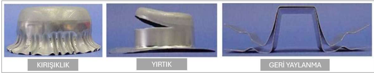
Şekil 1.5. Sac şekillendirme de deformasyon örnekleri
