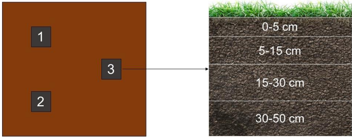
Şekil 19. Toprak çukurlarının işlem birimleri içerisindeki dağılımı ve örnekleme derinlikleri
