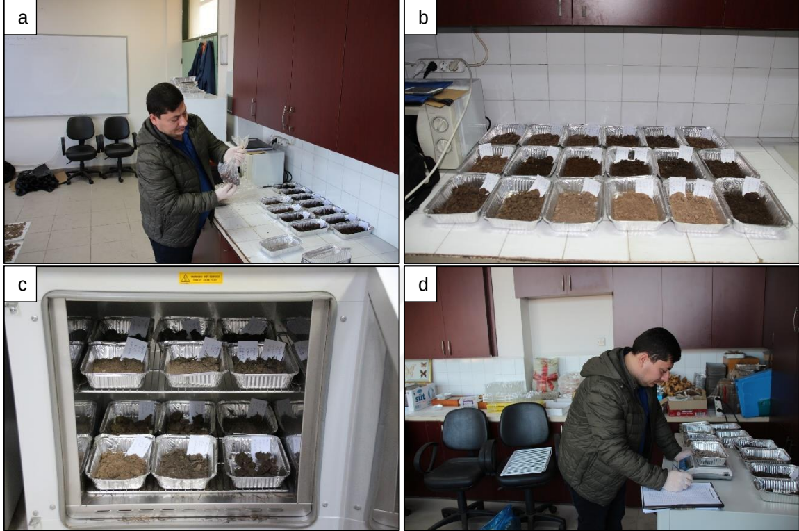
Şekil 24. Silindir örneklerinin alüminyum kaplara yerleştirilmesi (a ve b), kurutma fırınında kurutulması (c) ve fırın kurusu ağırlıklarının belirlenmesi (d)
