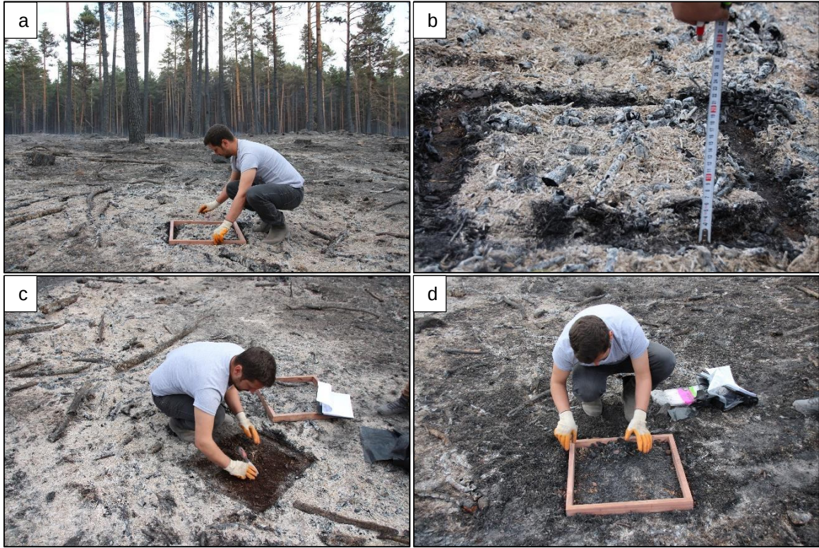
Şekil 41. Örnekleme alanının belirlenmesi (a), yanma kaybının ölçülmesi (b), yanıcı maddenin kesilmesi (c) ve plastik poşetlere konulması (d)
