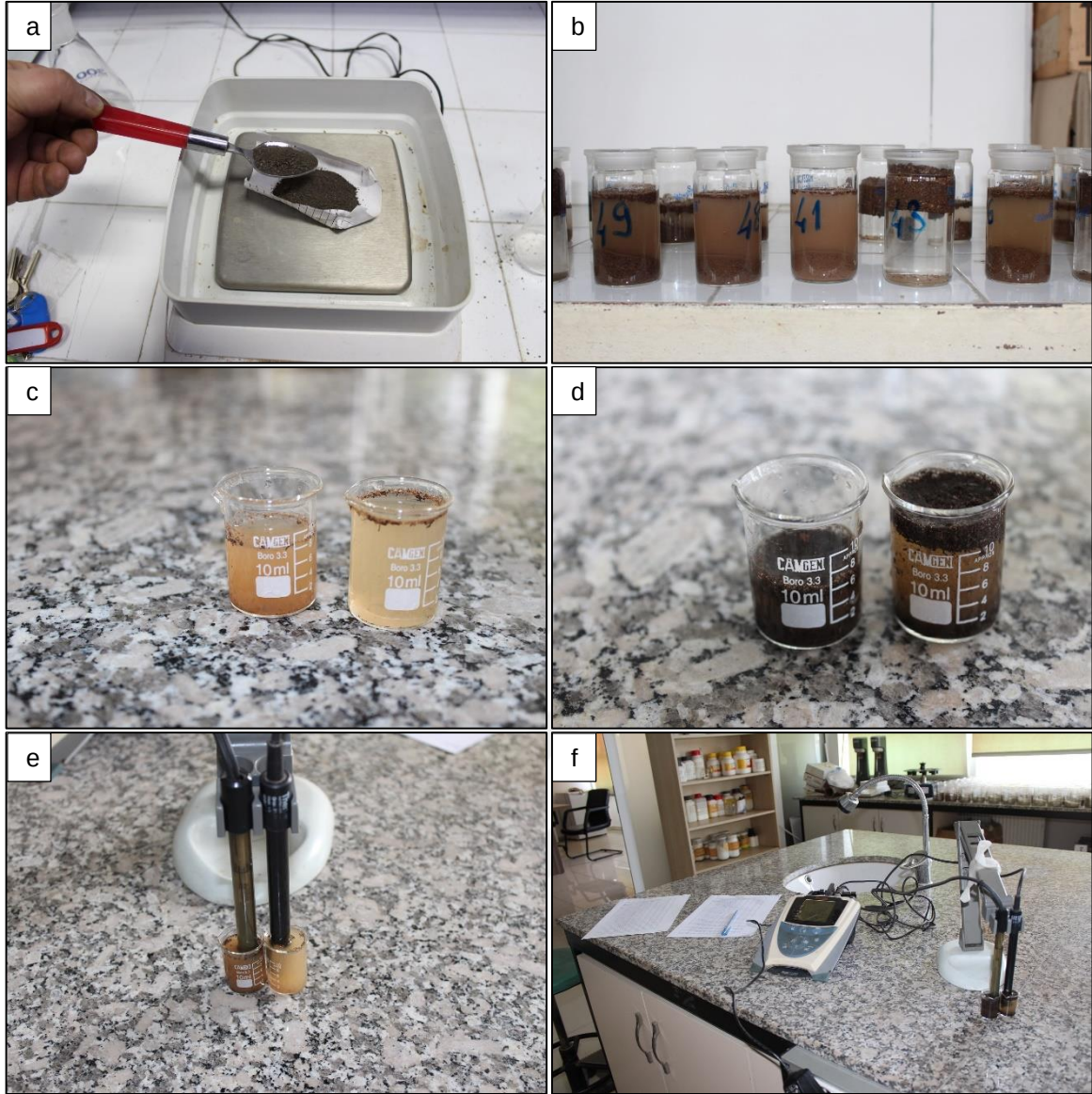
Şekil 25. Toprak örneklerinin tartılması (a), süspansiyonun hazırlanması (b), behere süzdürülmesi (c ve d) ve okumaların yapılması (e ve f)
