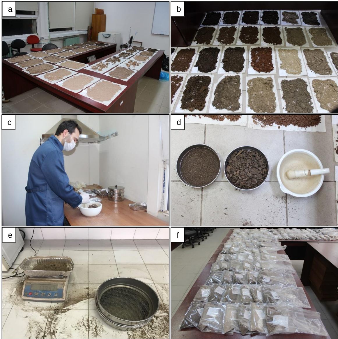
Şekil 21. Toprak örneklerinin hava kurusu hale getirilmesi (a ve b), havanda öğütülmesi (c ve d), elenmesi (e) ve plastik poşetlere konulması (f)
