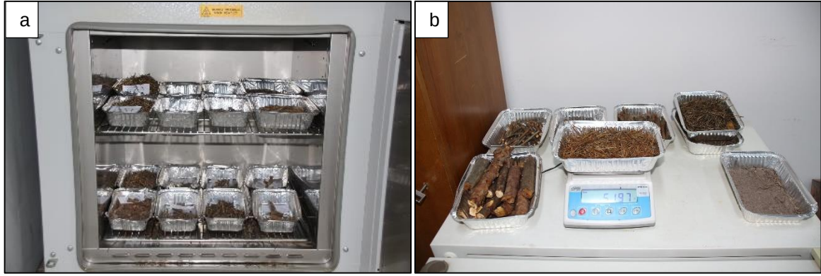
Şekil 18. Yanıcı madde örneklerinin kurutma fırınında kurutulması (a) ve fırın kuru ağırlıklarının belirlenmesi (b)
