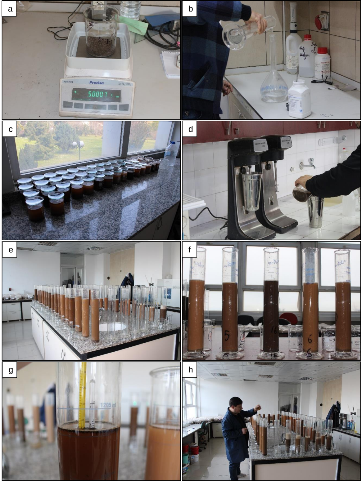
Şekil 23. Örneklerin tartılması ve behere konulması (a), kalgon çözeltisinin hazırlanması (b), hazırlanan süspansiyonun bekletilmesi (c), mikserde karıştırılması (d), hidrometre silindrine konulması (e ve f) ve okumaların yapılması (g ve f)
