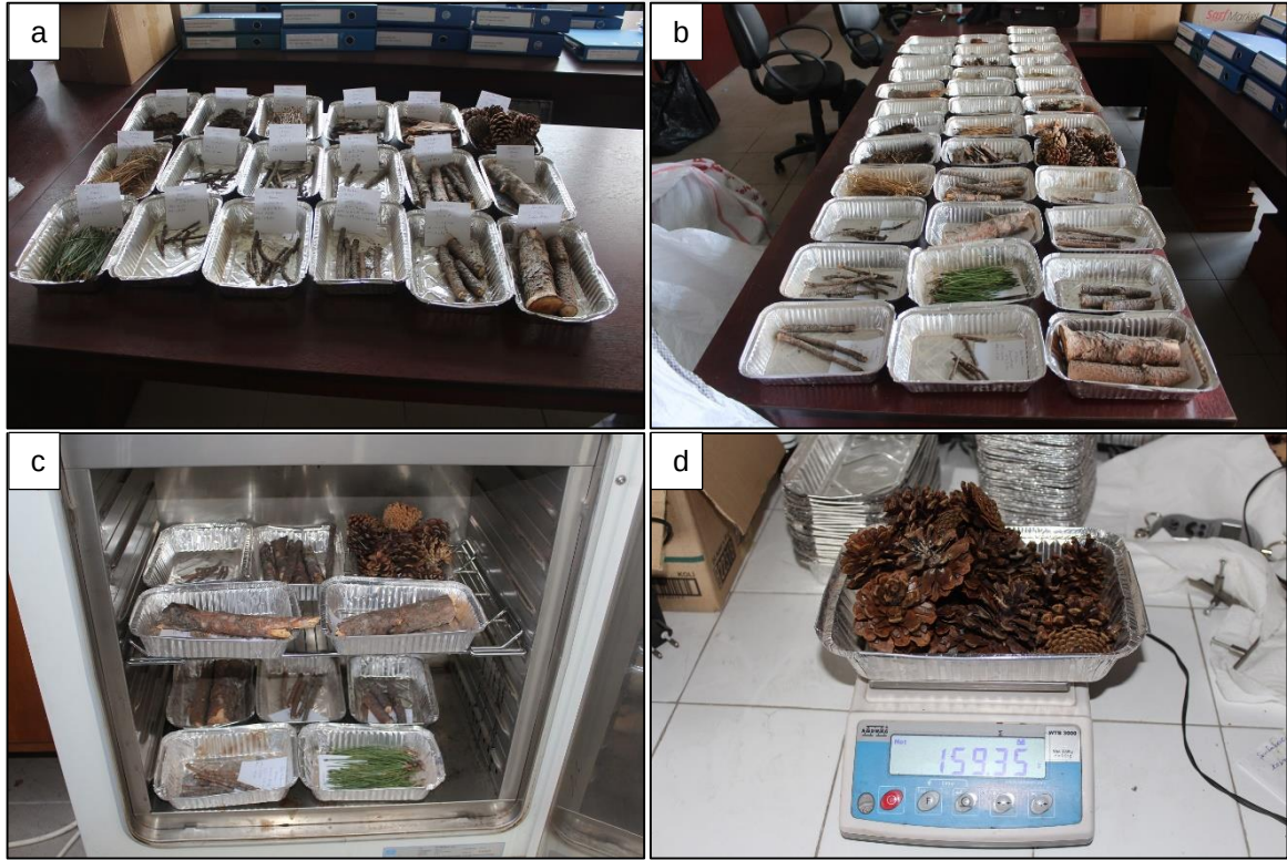
Şekil 27. Yanıcı madde nem örneklerinin alüminyum kaplara konulması (a ve b), kurutma fırınında kurutulması (c) ve fırın kurusu ağırlıklarının belirlenmesi (d)
