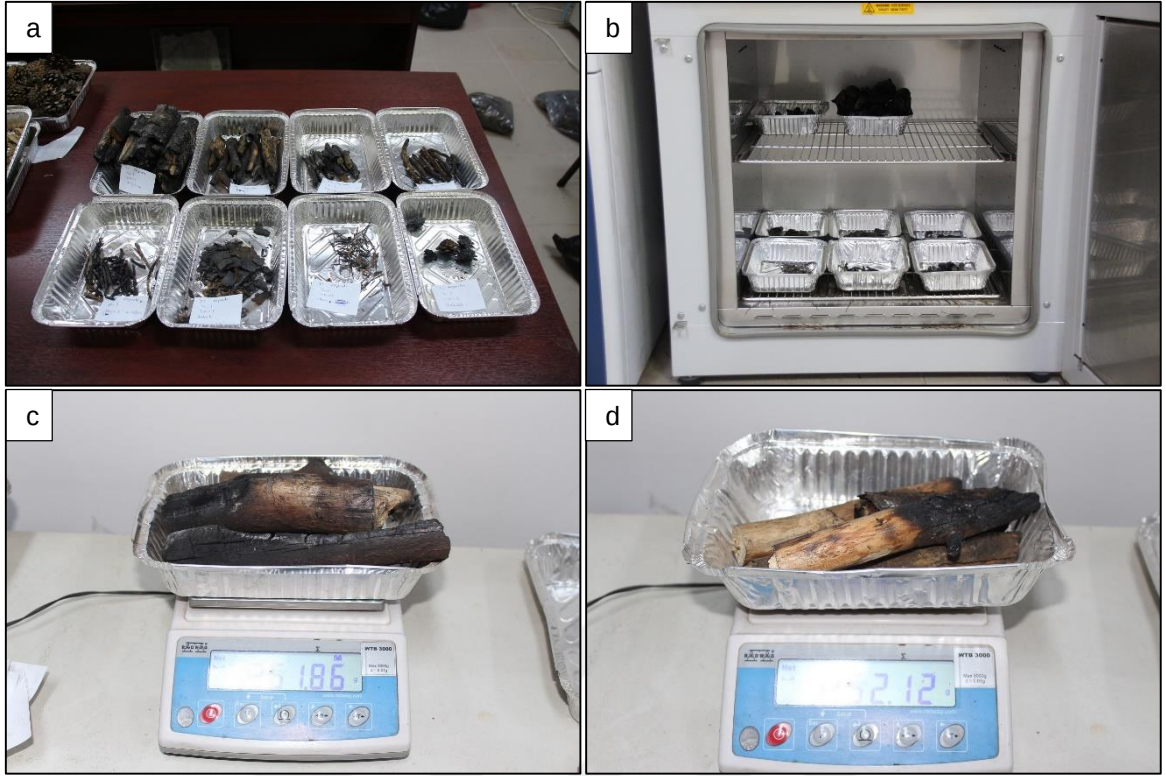
Şekil 42. Yanıcı madde örneklerinin sınıflandırılması (a), kurutma fırınında kurutulması (b) ve fırın kuru ağırlıklarının belirlenmesi (c ve d)
