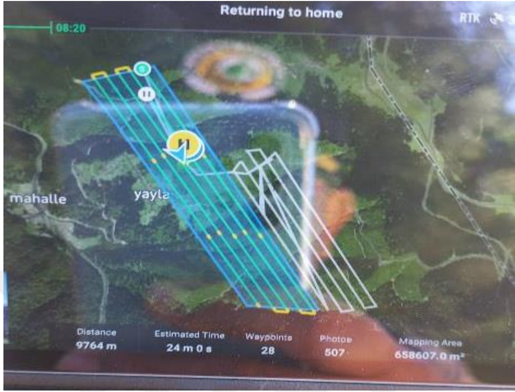
Şekil 12. Drone Kontrol Ünitesinin güzergah kontrol ekranı
