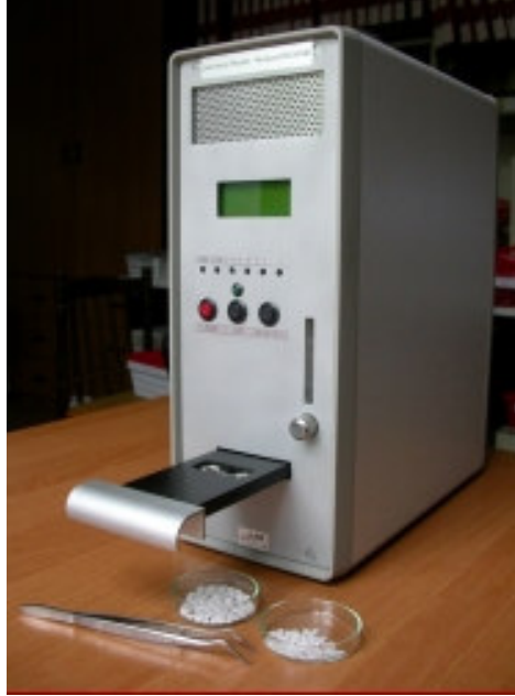
Şekil 4.2 RA'94 Reader-Analyser TLD sistemi
