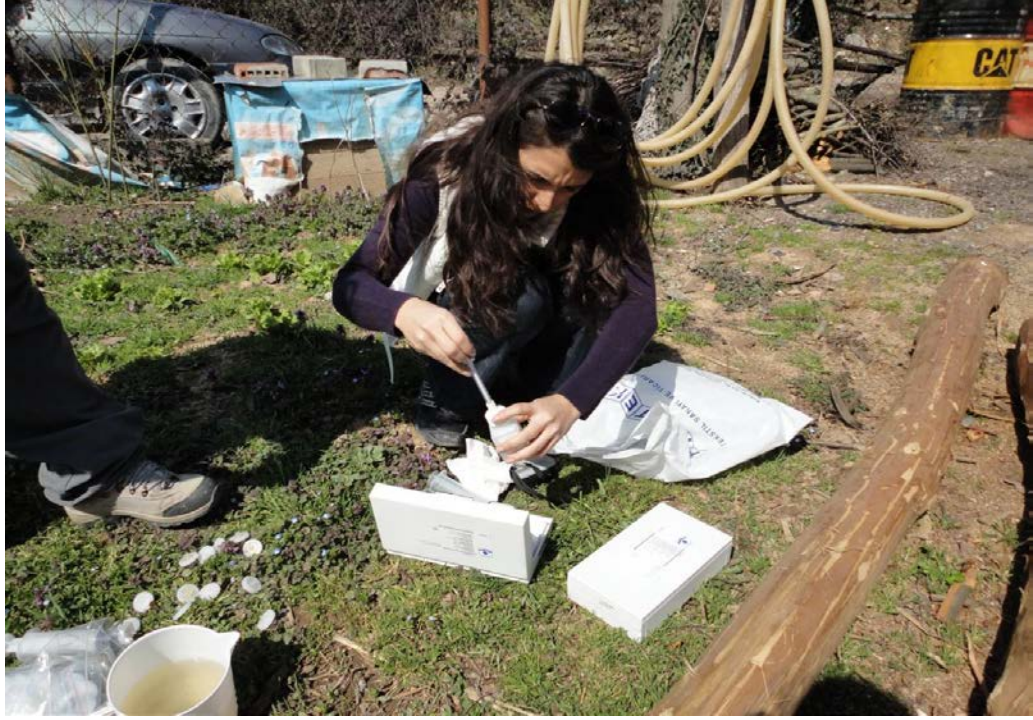
Şekil 3.20 : Alkalinite değerlerinin ölçümü işlemi
