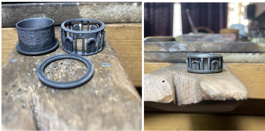
Şekil 5 19: Karartılan Yüzük Parçaları ve Birleştirilmesi.
