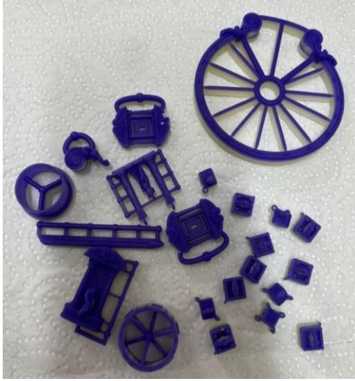
Şekil 5.14: Mum Kalıplar ve Dökümden Çıkan Parçalar. [Fotoğraf: Serhan Ertan, 10 Eylül 2024].
