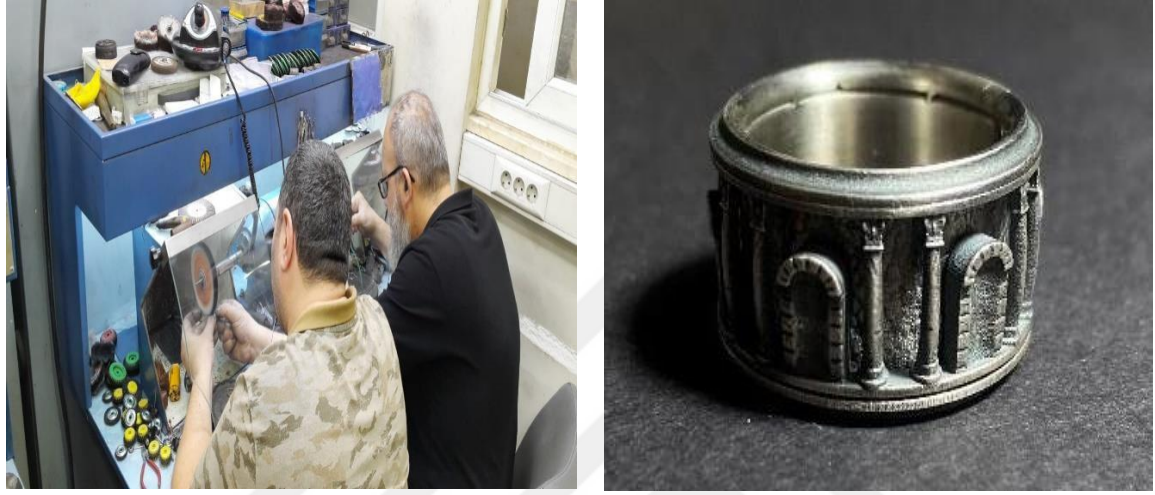
Şekil 5.20: Cila İşlemi ve Yüzüğün Bitmiş Hali.
