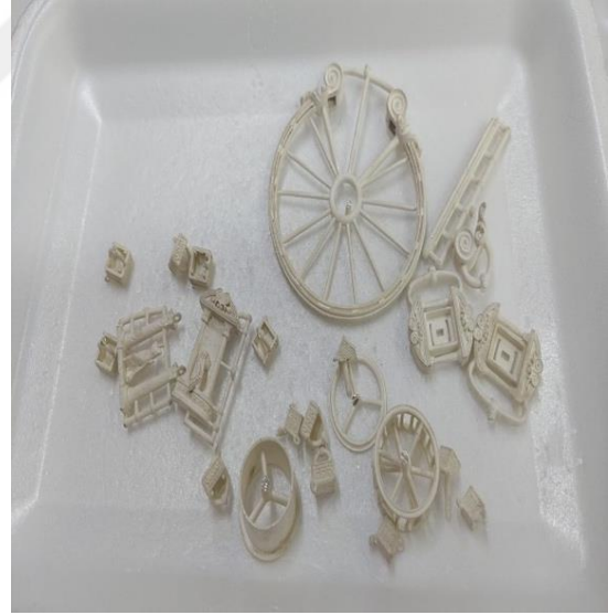
Şekil 5.14: Mum Kalıplar ve Dökümden Çıkan Parçalar. [Fotoğraf: Serhan Ertan, 10 Eylül 2024].
