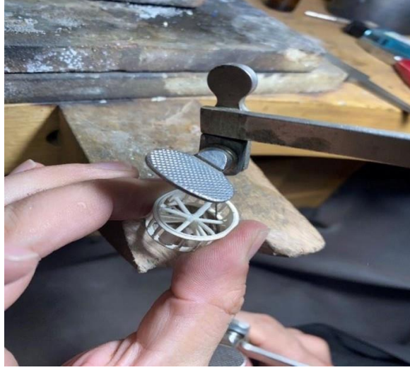
Şekil 5.15: Kıl Testere Yardımıyla Yollukların Kesimi.
