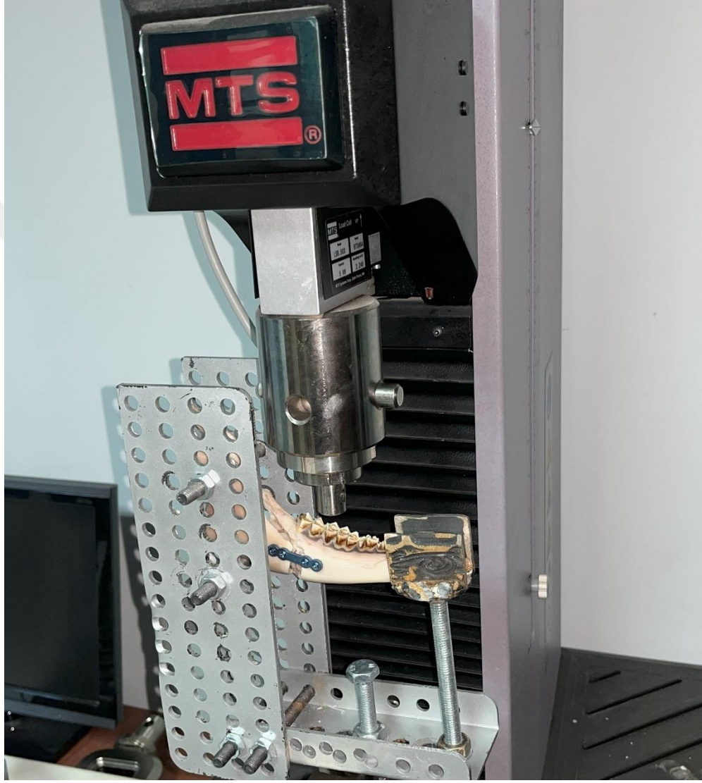
Şekil 3.9. Deneklerin test cihazına yerleştirilmesi molar dişler üzerine kuvvet uygulanması
