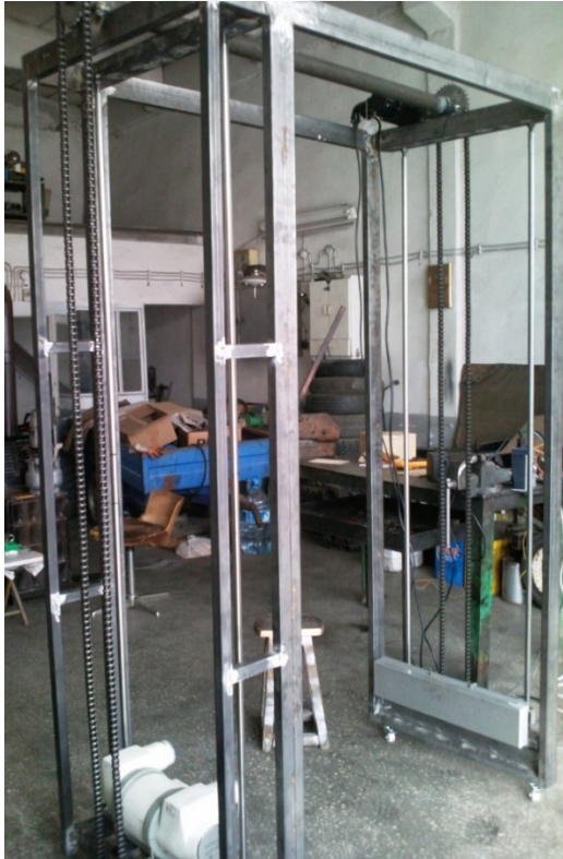
Şekil 3.16. Demir atölyesinde mekanik aksam yapım aşamaları
