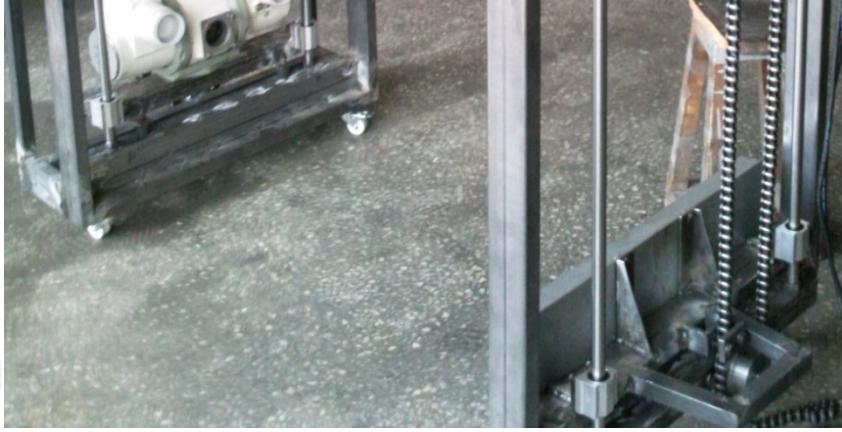
Şekil 3.14. LAD radyografi cihazı doğrusal yataklama
