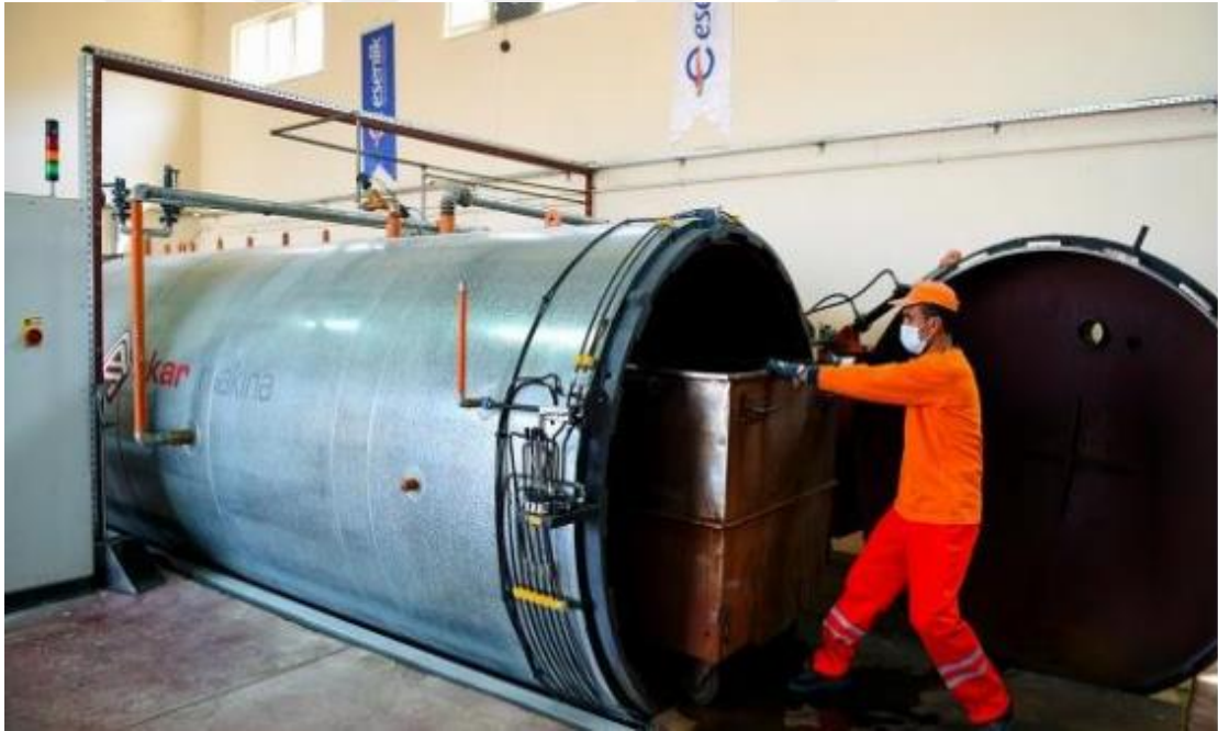
Resim 1.5. Tıbbi atık sterilizasyonu otoklav ünitesi (Varolgüneş, 2018)
