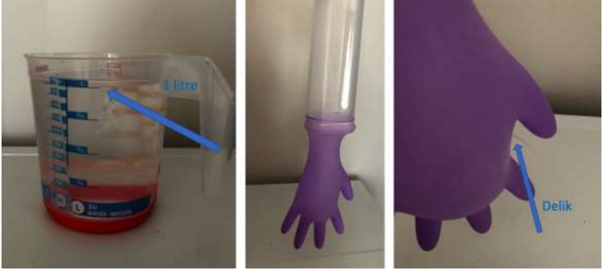
Resim 4.8. EN 455 için bariyer testi deneyi
