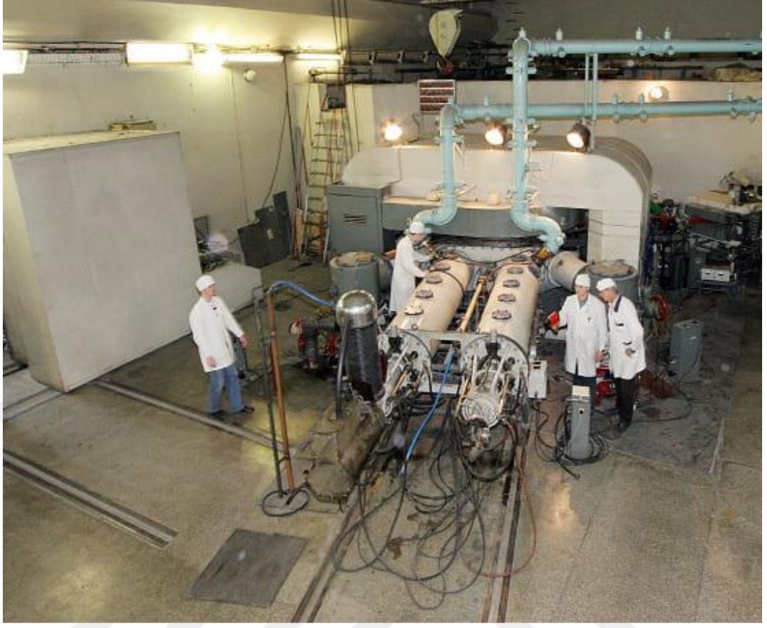
Şekil 4.1. Kazakistan Ulusal Nükleer Merkezi'nin Nükleer Fizik Enstitüsü'nde bulunan U-150M eşzamanlı siklotronu
