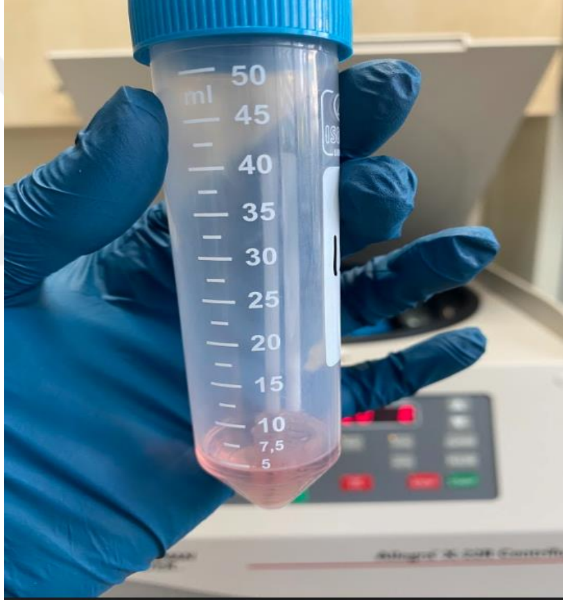
Şekil 3.1. 50 ml falkon tüpte RPMI solüsyonu içerisinde santrifüj edilen fırçalar
