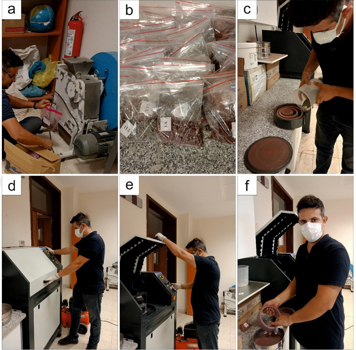
Şekil 3.6. a) Kayaç kırıcı işlemi b) Çakıl boyutundaki örneklerin paketleme ve etiketlenmesi c) Numunelerin halkalı öğütücü havanına eklenmesi d) Halkalı öğütücü çalıştırma işlemi e) Tamamlanan öğütme işlemi f) Numunelerin halkalı öğütücüden eleğe aktarımı
