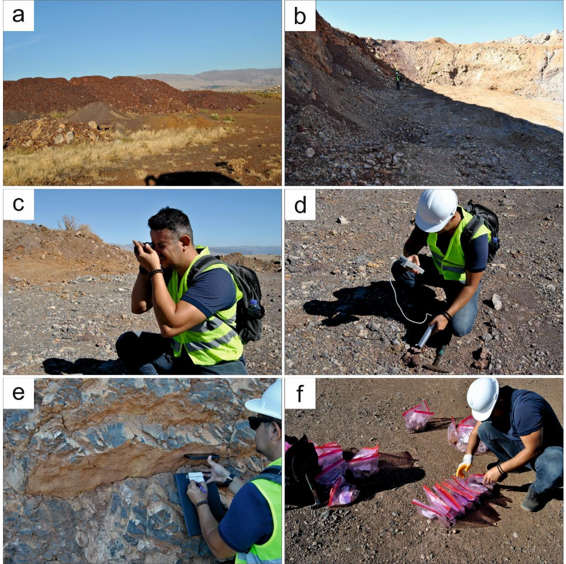
Şekil 3.5. a) Boksit stoğu b) Kuzey açık boksit ocağı c) Lup kullanımı d) Radyasyon ölçümü e) Tabaka doğrultu ve eğim yönü ve miktarı ölçümü f) Numunelerin paketlenmesi
