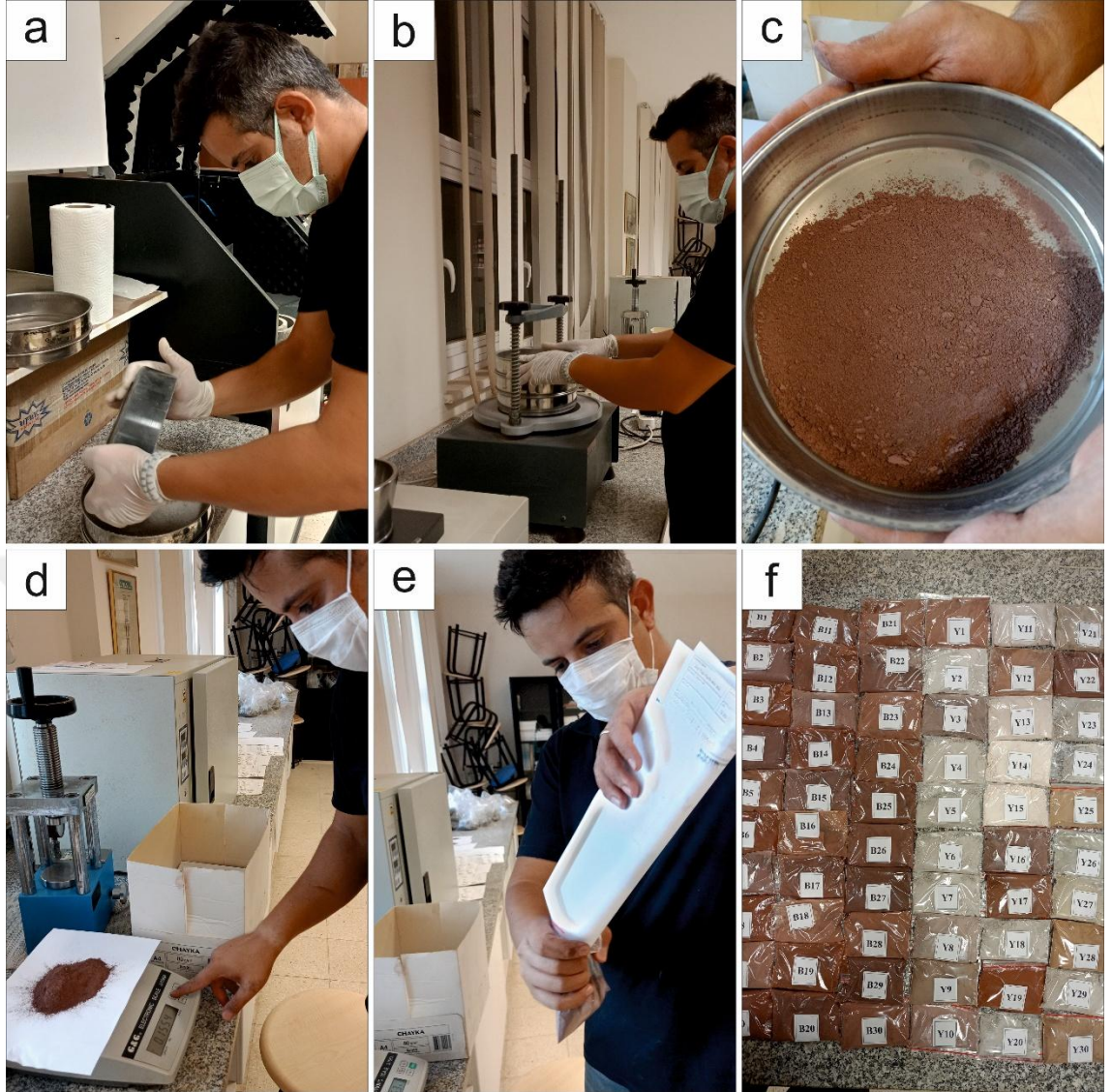
Şekil 3.7. a), b), c) Öğütülen numunelerin elekten geçirilmesi d) Elekten geçirilen numunelerin tartılması e), f) Numunelerin paketleme etiketleme işlemleri
