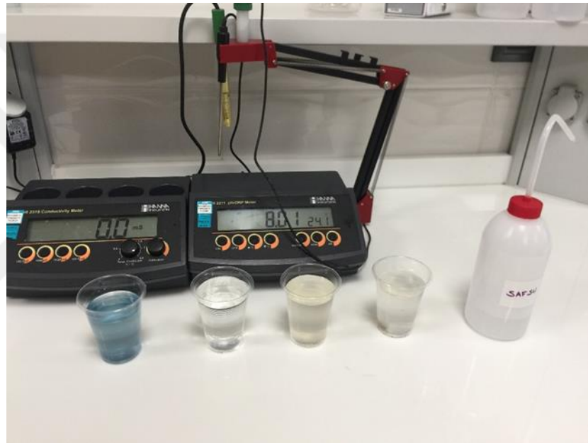
Şekil 5.2. ph metre ve iletkenlik ölçme cihazı
