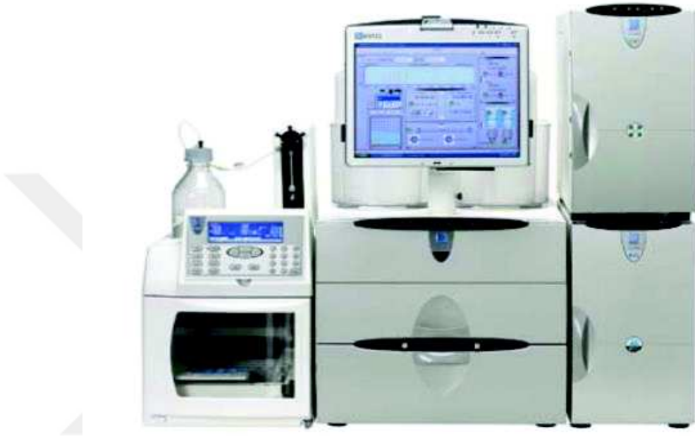
řekil 4.2. DIONEX ICS-3000 DC İyon kromatografisi [30].
