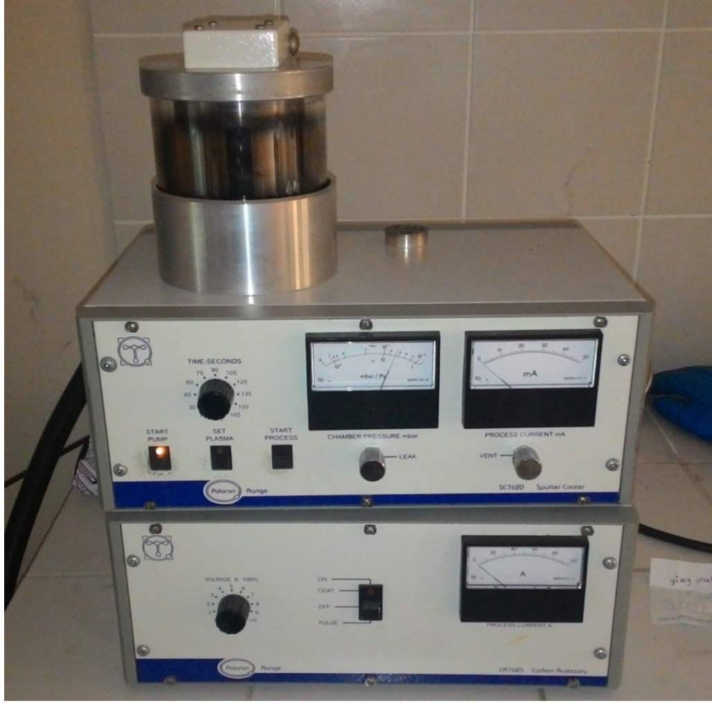
Şekil 2.6. Stub üzerindeki örnekleri altın tozu ile kaplama makinası
