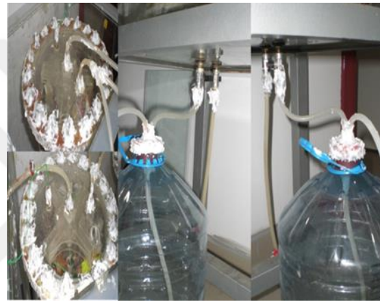
Şekil 4.14. Reaktörlerin bağlantı noktalarının köpüklenmesi
