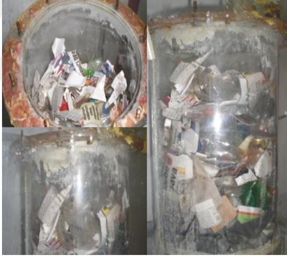
Şekil 4.12. Katı atık örnek numunelerin reaktörlere yerleşimi
