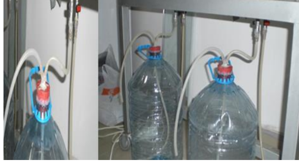
Şekil 4.9. Reaktörlerin alt sızıntısıuyu haznesi
