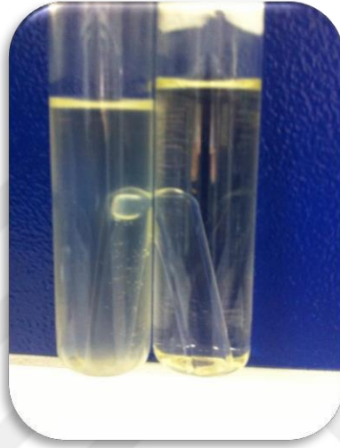
Şekil 3.11. Laktöz Broth pozitif sonuç (sol) negatif sonuç (sağ)
