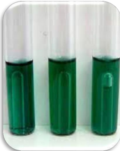
Şekil 3.12. Brillant Green Laktöz Broth pozitif Sonuç (sağ)
