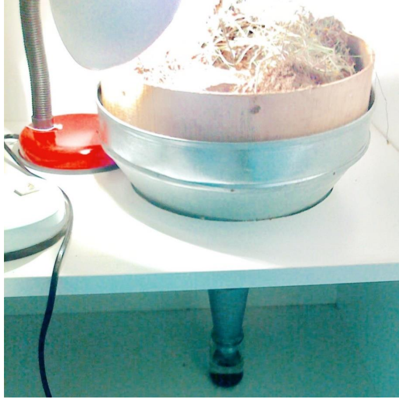
Şekil 2.3. Berlese hunilerinden oluşan ayıklama düzeneği
