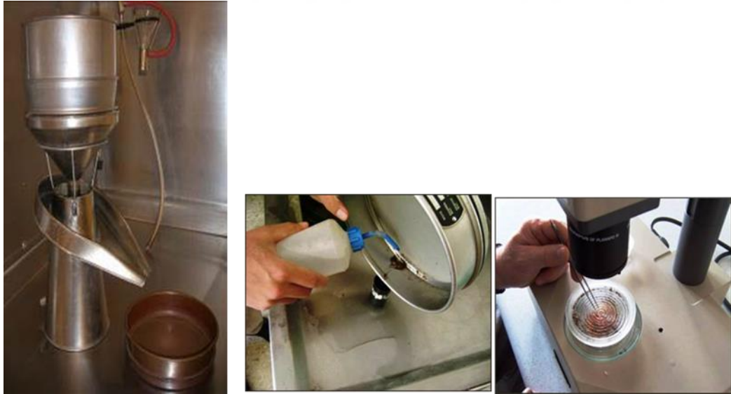
Şekil 3.2. Toprak ve Kök Örneklerinden Kistlerin Elde Edilmesinde kullanılan Kort Cihazı
