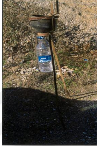
Şekil 4.7. Stok alanına kurulan çöken toz ölçüm cihazı
