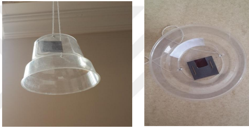
řekil 3.3. Radon Ölçümleri İçin Hazırlanan LR-115 Dedektörleri
