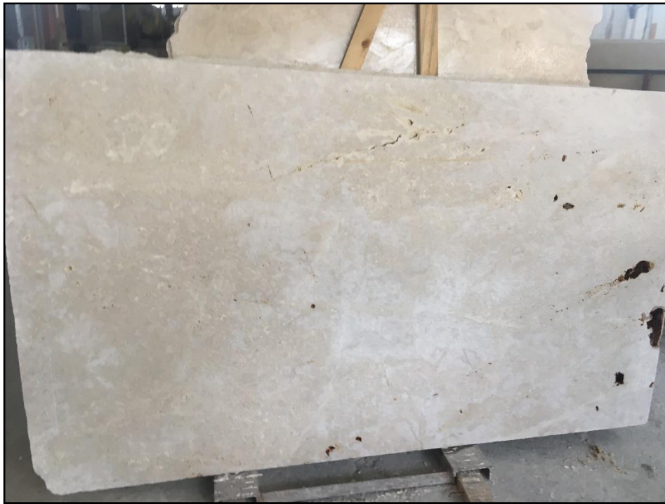
Şekil 4.3. Mermer plakasında bulunan boşluklar
