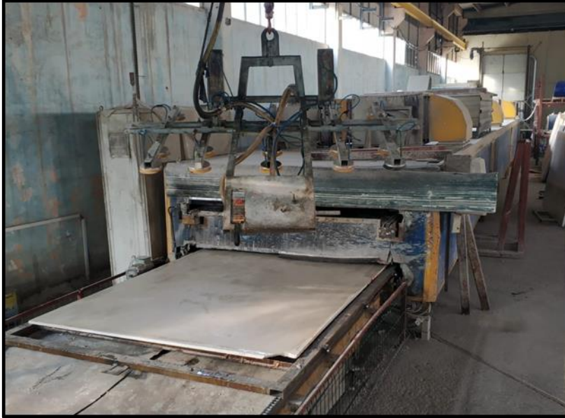
Şekil 3.12. Epoksi hattında tünel fırına gönderilen mermer plakası
