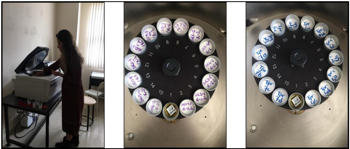
Şekil 3.16. Pelletlerin XRF cihazına yerleştirilmesi
