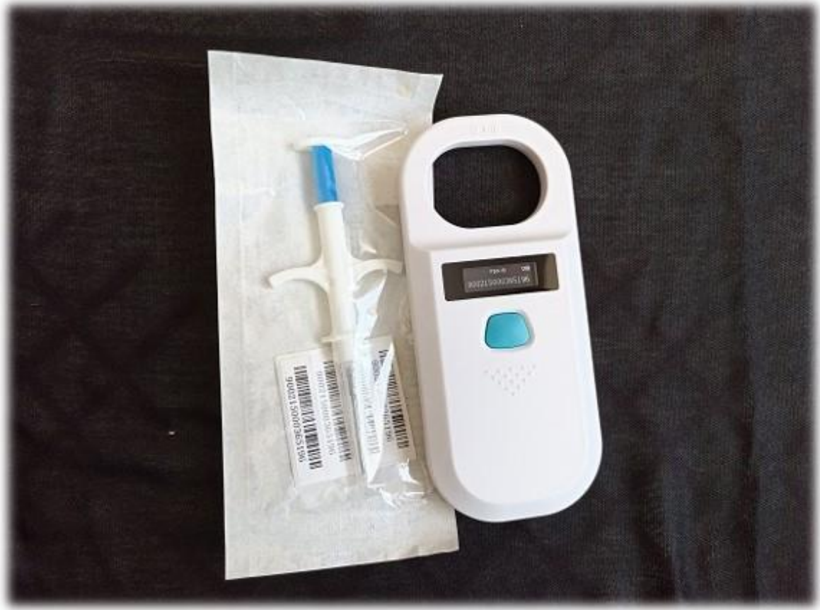
Görsel 3.3. Markalama çalışmalarında kullanılan Radyo Frekanslı Tanımlama Sistemi (RFID) temelli PIT (Passive integrated Transponders) mikroçip (solda) ve mikroçip okuyucu (sağda)
