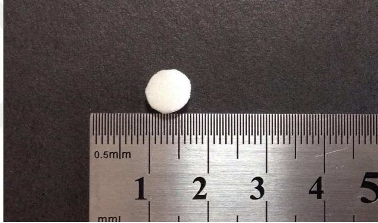
Şekil 3.2. Üretim sonrası 6 mm çapında kesilmiş olan kitosan doku iskelesi.
