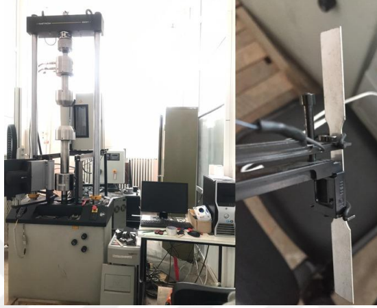
Şekil 3.3. KTÜN'de Ti-6Al-4V alaşımına uygulanan çekme testi.
