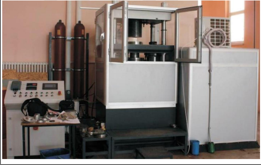
Şekil 3.7. KTÜN Makine Mühendisliği Bölümü laboratuvarında bulunan HŞ presi. Şekilde pres gövdesi, HNC kontrolcü ve basınç aküleri görülmektedir.
