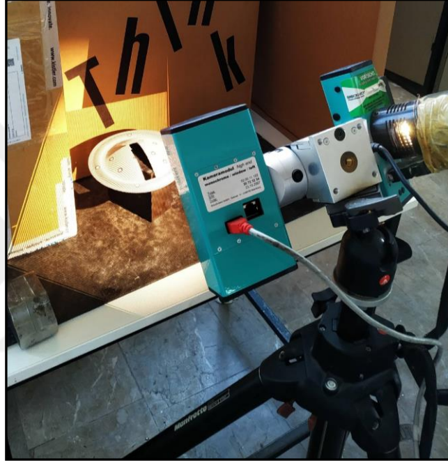
Şekil 3.11. KTÜN laboratuvarında bulunan optik tarama ile yapılan tersine mühendislik ölçümü.
