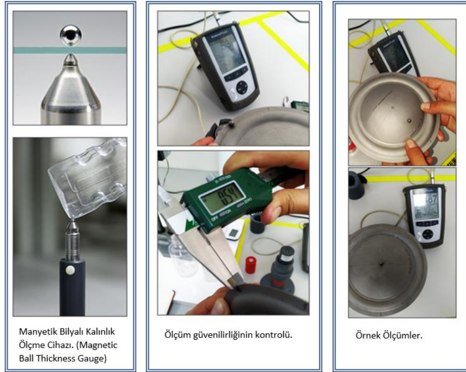
Şekil 3.21. Manyetik bilyalı kalınlık ölçme cihazının çalışma prensibi ve yapılan ölçümlerden örnekler.
