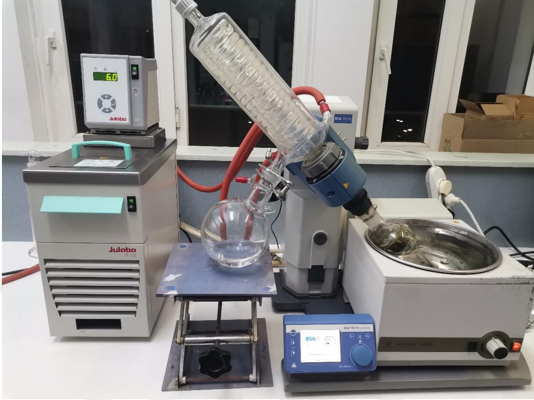
Şekil 3.3. Elde edilen ekstraktlardan çözücünün uzaklaştırılması için kullanılan evaporatör düzeneği.
