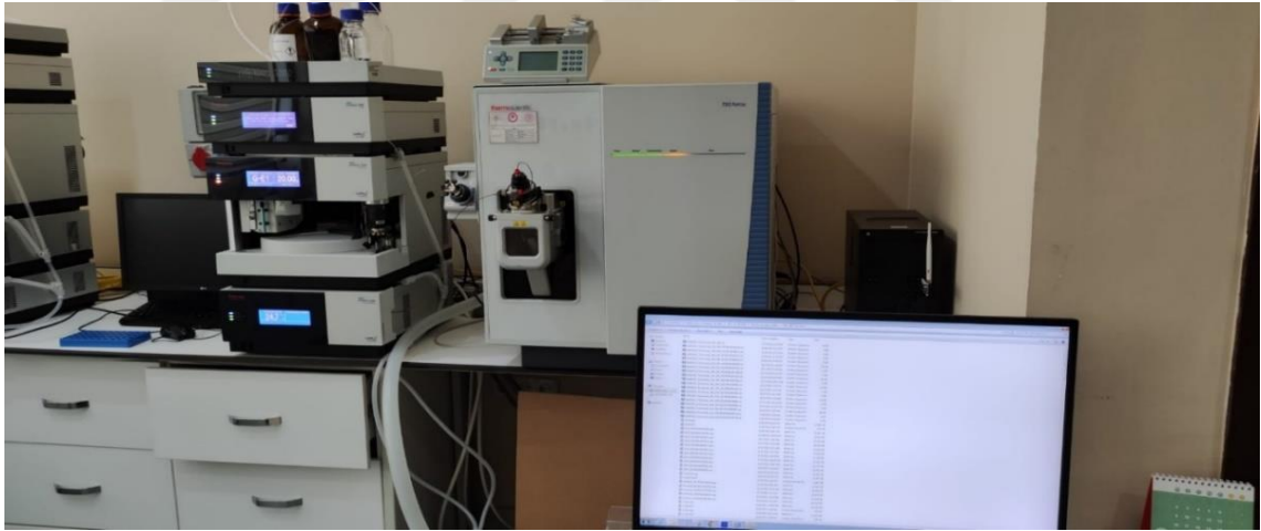
Şekil 3.5. Fenolik bileşen içerik tayinin yapıldığı UHPLC-MS/MS cihazını
