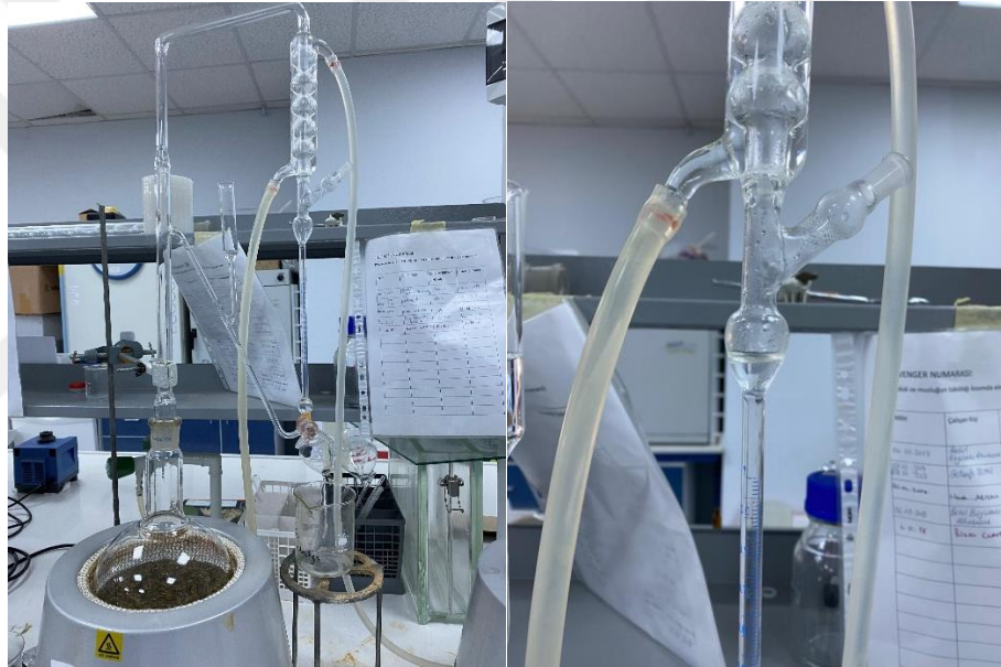
Görsel 3.3. Uçucu yağ eldesi ve Clevenger apareyi
