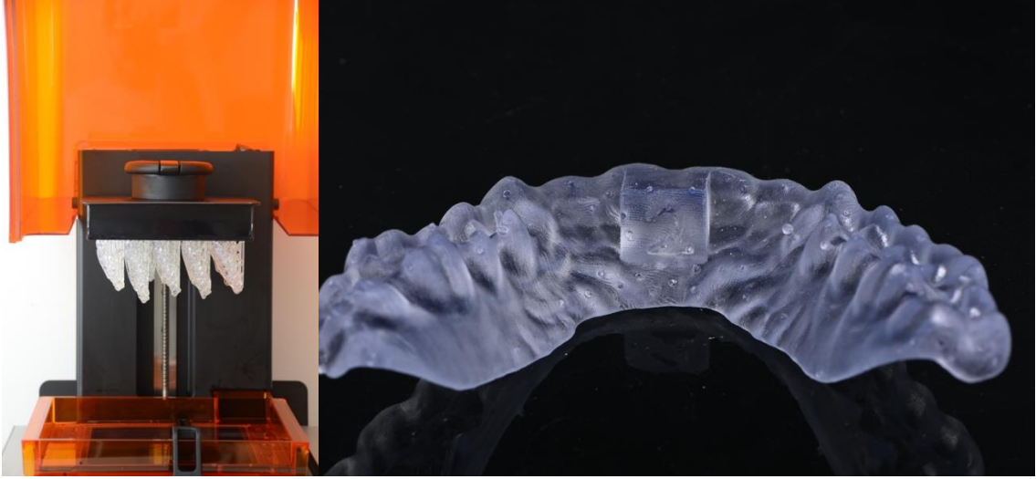
Şekil 3-14: Ağız içi fonksiyonel kayıt apareyinin 3 boyutlu baskısının tamamlanması ve işlemler tamamlandıktan sonraki görüntüsü
