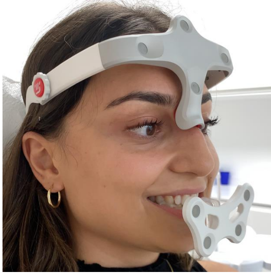
Şekil 3-8: Cihazın kayıt hareketleri sırasında kameraların görüntüyü takip edebilmesine yardımcı olan araçların denek üzerine yerleştirilmiş hali.
