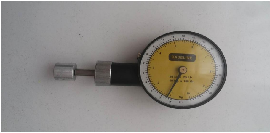
Resim 1. Çalışmada kullanılan Baseline Algometre (66 Lb/30 Kg)
