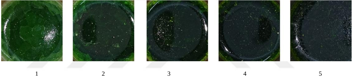
Görsel 4.12. 1100^\circ\text{C} 'de krom(III)oksit ( \text{Cr}_2\text{O}_3 )kullanarak üretilen yeşil camlar. Sırayla soldan: 1: %0.1, 2: %0.3, 3: %0.5, 4: %1 ve 5: %3.
