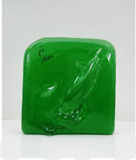
Görsel 5.11. 1200°C'de döküm yapılan çim yeşili renkli cam (%0.1 Cr 2 O 3 )
