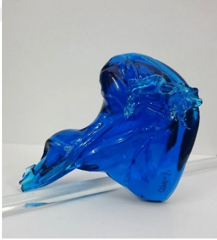
Görsel 5.12. 1150°C'de döküm yapılan koyu turkuaz cam (%1 CuO)
