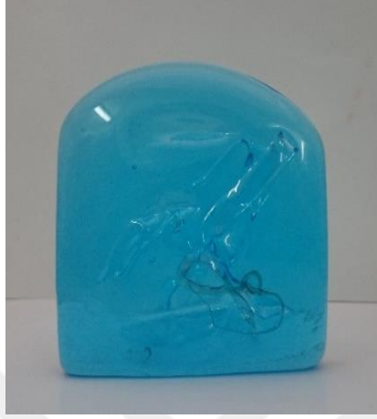
Görsel 5.9. 1200°C’de döküm yapılan turkuaz renkli cam (%0.3 CuO)
