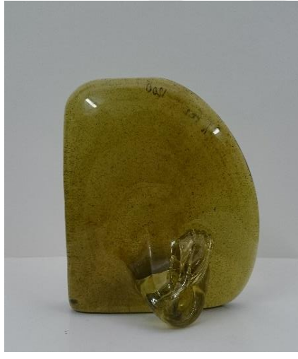
Görsel 5.10. 1200°C’de döküm yapılan zeytin yeşili renkli cam (%3 Fe 2 O 3 )
