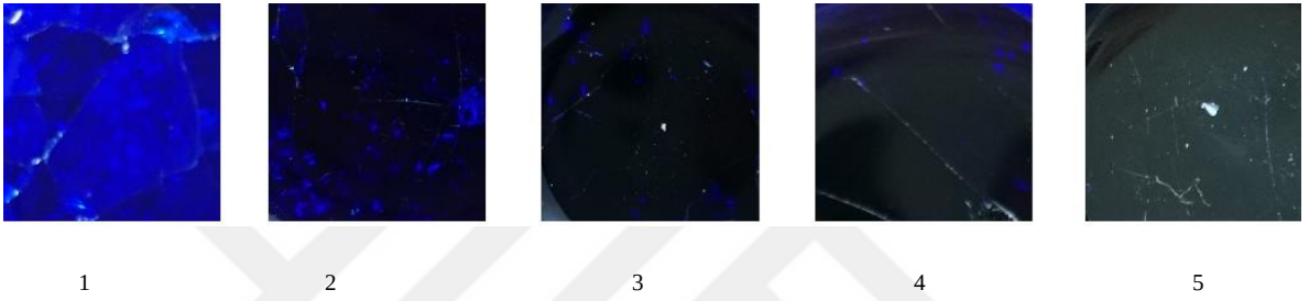
Görsel 4.33. 1200°C’de kobalt oksit kullanarak üretilen lacivert camlar.
