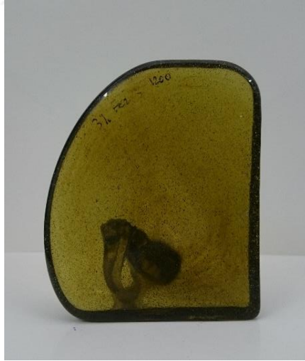
Görsel 5.10. 1200°C’de döküm yapılan zeytin yeşili renkli cam (%3 Fe 2 O 3 )
