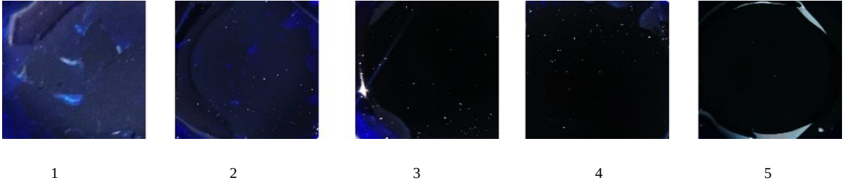
Görsel 4.32. 1150°C’de kobalt oksit kullanarak üretilen lacivert camlar.
