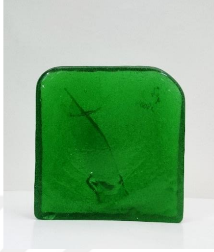
Görsel 5.11. 1200°C'de döküm yapılan çim yeşili renkli cam (%0.1 Cr 2 O 3 )
