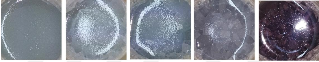
Görsel 4.9. 1100° C’de mangan(IV) dioksit ( MnO_2 ) kullanarak üretilen mor camlar. Sırayla soldan: %0.1, %0.3, %0.5, %1 ve %3.
