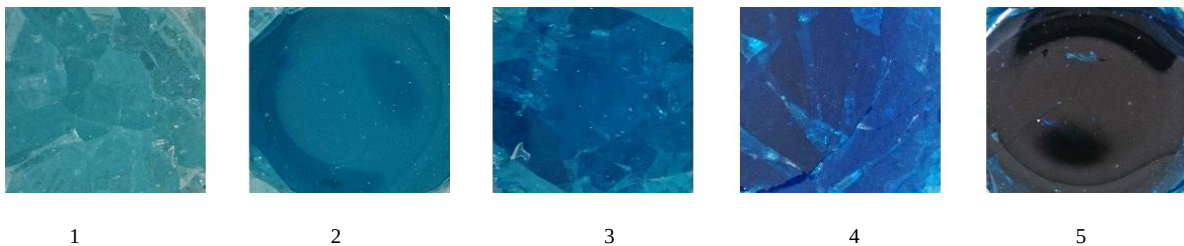
Görsel 4.28. 1150^{\circ}\text{C} 'de Bakır(II) oksit ( \text{CuO} ) kullanarak üretilen turkuaz camlar.
