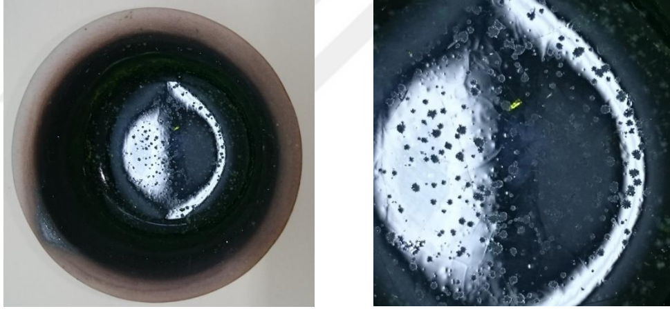
Görsel 4.16. 1150°C’de ve %3 numunede oluşan kristaller.
