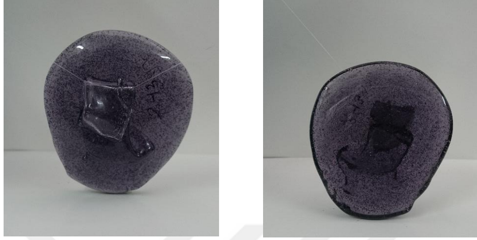
Görsel 5.13. 1200°C’de döküm yapılan mor cam (%5 MnO 2 )
