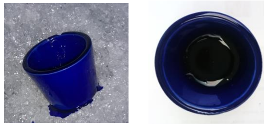
Görsel 4.34. 1150°C’de üretilen %3 kobalt oksit içeren numune
