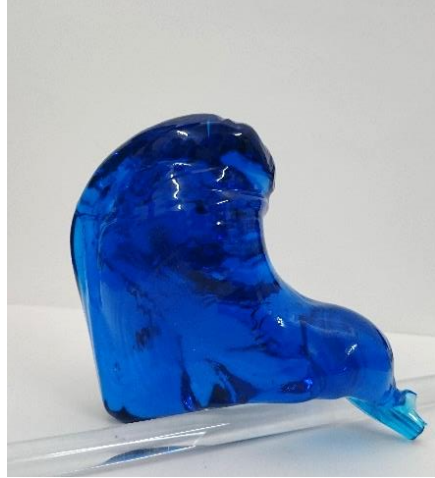
Görsel 5.12. 1150°C'de döküm yapılan koyu turkuaz cam (%1 CuO)
