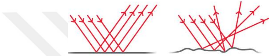
Görsel 3.3. (solda) Düz yüzeyde ışık yansıması ve pürüzlü yüzeyde ışık saçılması (sağda).
