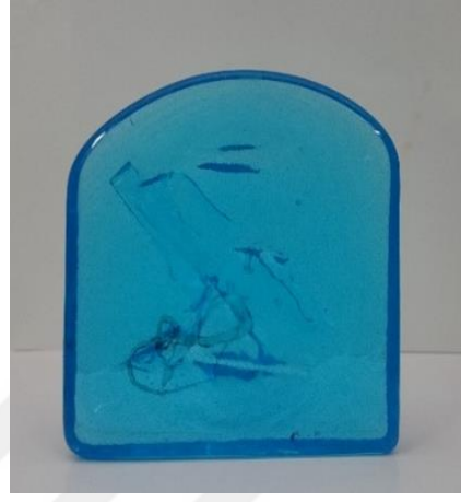
Görsel 5.9. 1200°C’de döküm yapılan turkuaz renkli cam (%0.3 CuO)
