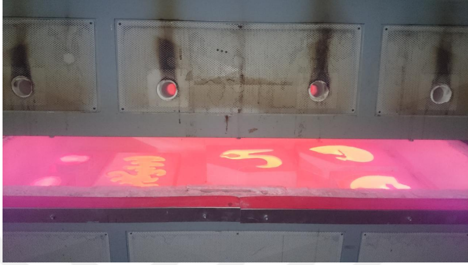
Görsel 5.15. maksimum sıcaklıkta fırının aşamalı soğutulması
