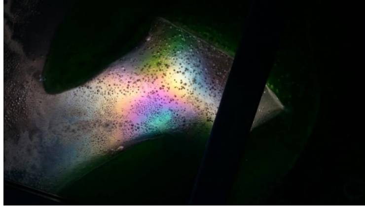
Görsel 5.21 “Ebedi” adlı çalışmanın tansiyon bölgeleri polariskop altında
