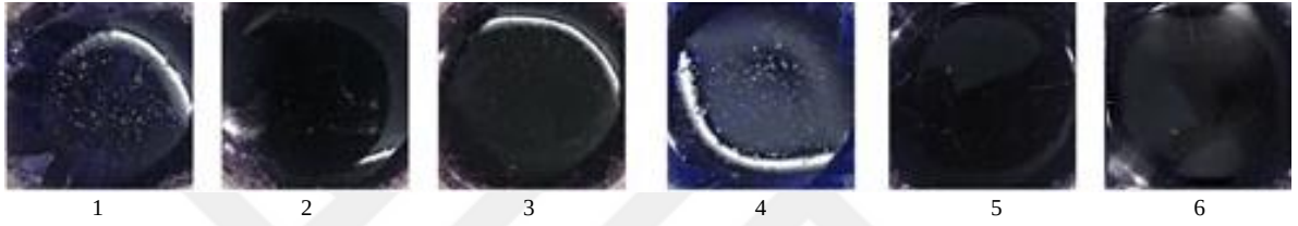
Görsel 4.23. 1100°C'de kobalt oksit ve manganez dioksit kullanarak üretilen morumsu mavi camlar. Sırayla soldan: 1: % 0.002 CoO+%3MnO 2 , 2: % 0.002CoO+% 5 MnO 2 , 3: % 0.002CoO+%7 MnO 2 , 4: % 0.006 CoO+%3 MnO 2 , 5: % 0.006 CoO+% 5 MnO 2 , 6: % 0.006CoO+% 7 MnO 2 .
