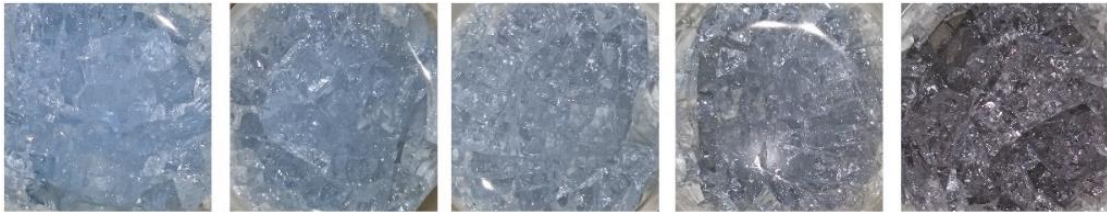
Görsel 4.11. 1200°C’de mangan (IV) dioksit ( MnO_2 ) kullanarak üretilen mor camlar. Sırayla soldan: %0.1, %0.3, %0.5, %1 ve %3.
