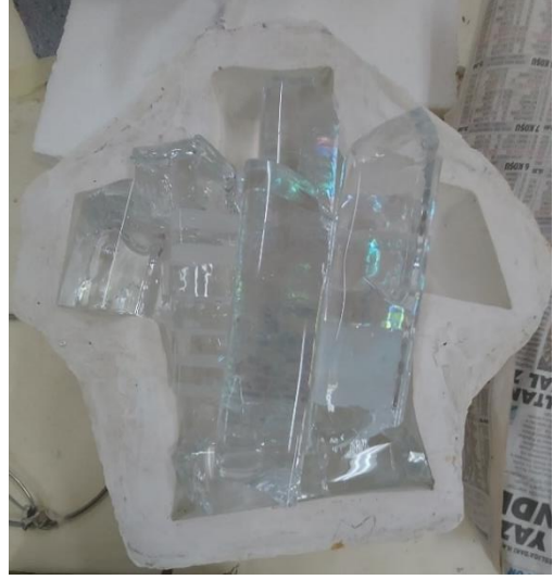
Görsel 5.25. Model Boşluğuna Cam Doldurulan Kalıp
