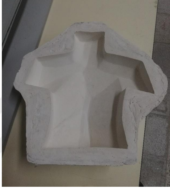
Görsel 5.23. Kalıpla Şekillendirme Kil Modelin Kalıbı (Fotoğraf: Deniz KÜÇÜKBALLILAR)
