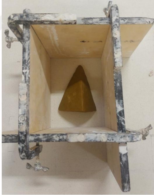
Görsel 5.17. Modelin Etrafına Kalıp Tahtasının Döşenmesi (Fotoğraf: Deniz KÜÇÜKBALLILAR)
