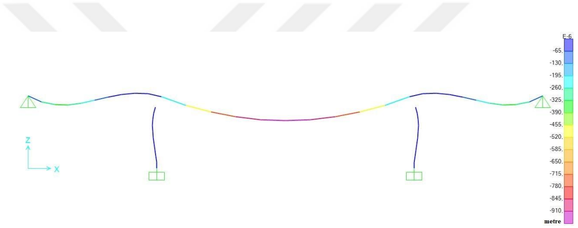
Şekil 4.30 Köprü üzerinden 6 araç geçirildiğinde köprü yapısında, z eksenindeki yer değiştirmeler
