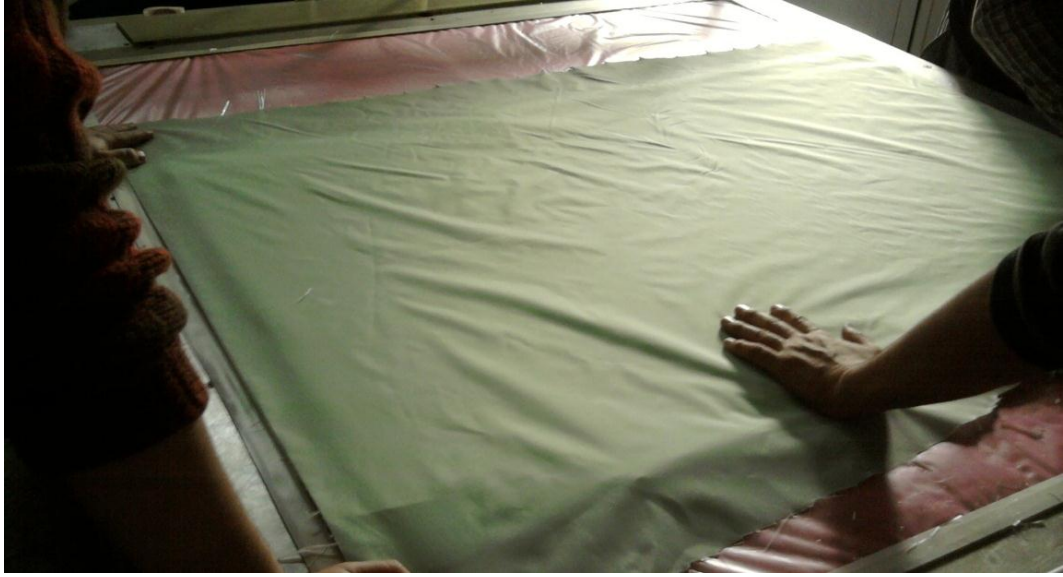
Şekil 3.9 Soyma kumaşının cam-elyaf üzerine yerleştirilmesi
