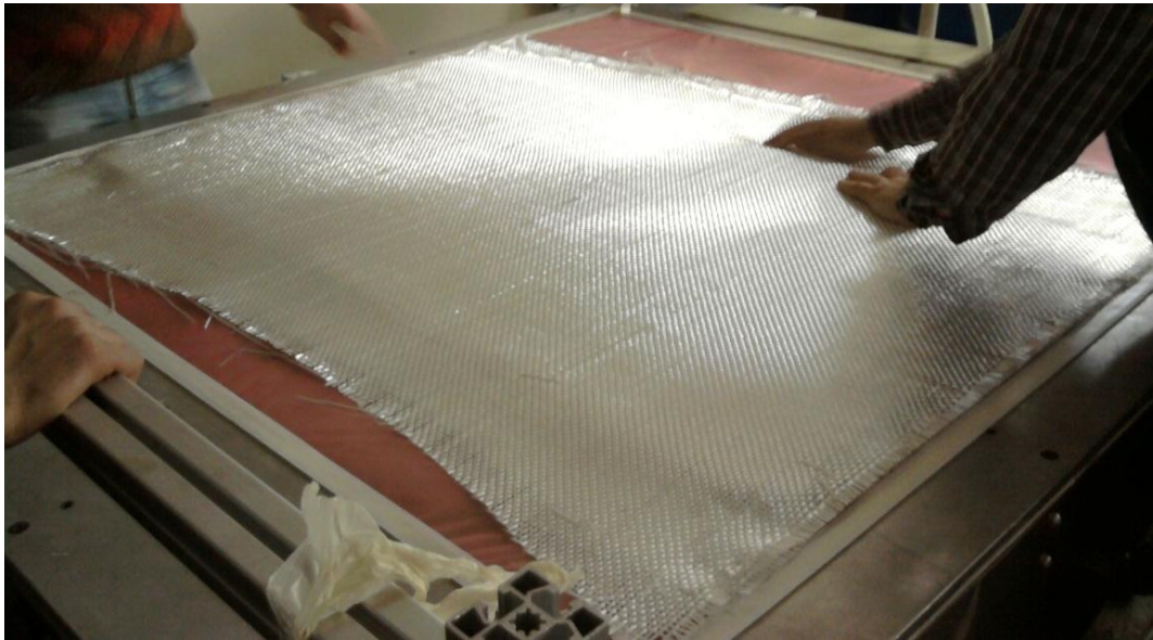
Şekil 3.8 Elyafların PVC köpüğün üzerine yerleştirilmesi
