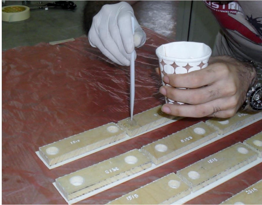
Şekil 4.8 Deliklerin dolgu ile doldurulması işlemi
