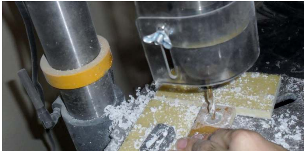
Şekil 4.10 Pim deliklerinin delinmesi işlemi
