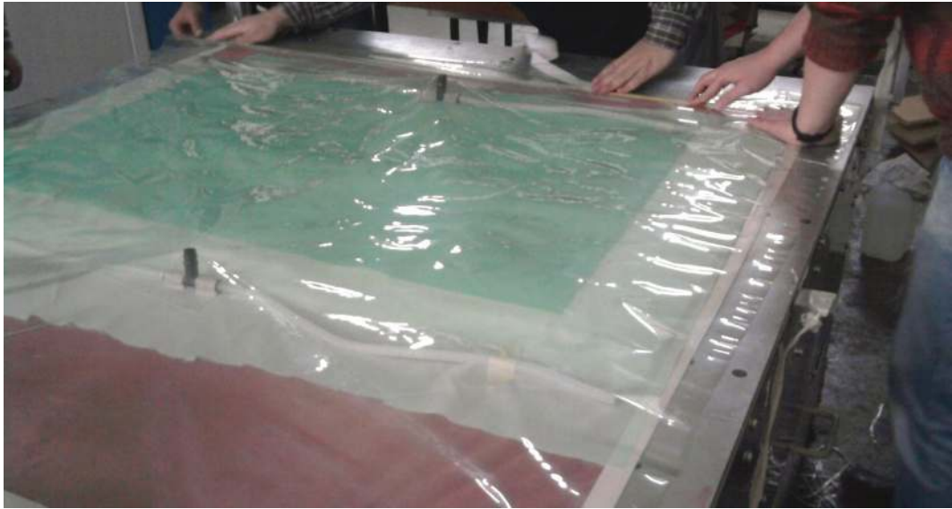
Şekil 3.10 Vakum torbasının yerleştirilmesi
