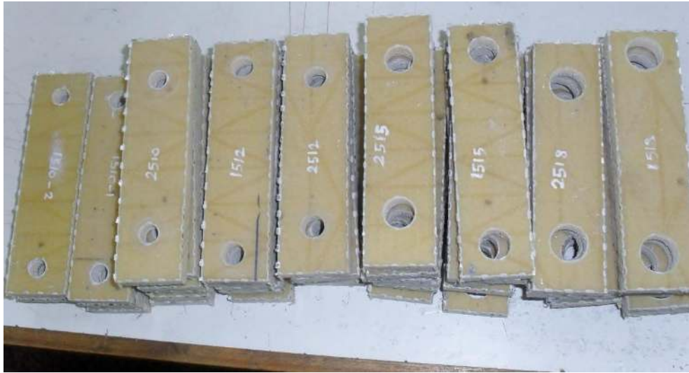
Şekil 4.7 İlk delik delme işlemi uygulanmış olan numuneler
