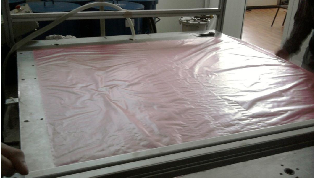
Şekil 3.5 Kalıp ayırıcı olarak kullanılan polilefin filmin serilmesi
