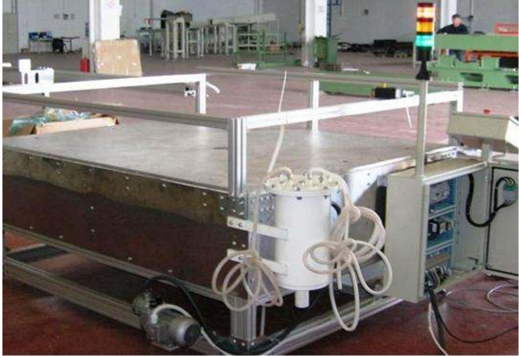
Şekil 3.2 Kompozit plaka üretim tezgâhı
