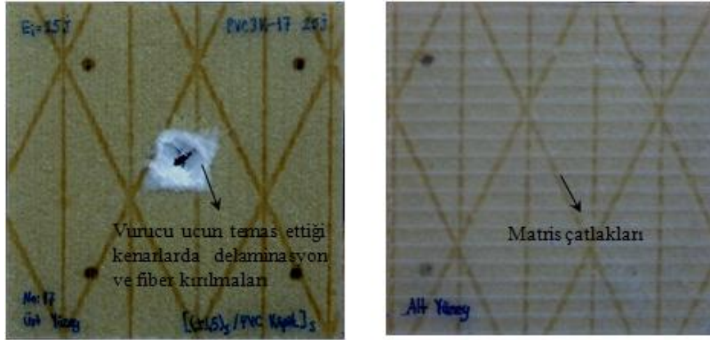
Şekil 5.26 [(\pm 45)_3/\text{PVC Köpük}]_s oryantasyonlu sandviç kompozit numunenin 25 J’de yapılmış darbe deneyi sonrası üst ve arka yüzeylerinden fotoğrafları
