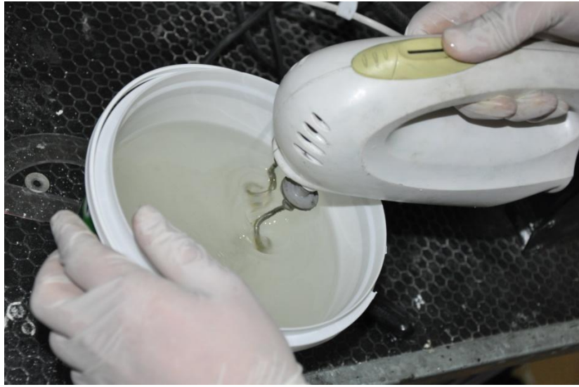
Şekil 4.13 Belli oranlardaki reçine ve sertleştiricinin karıştırılması.
