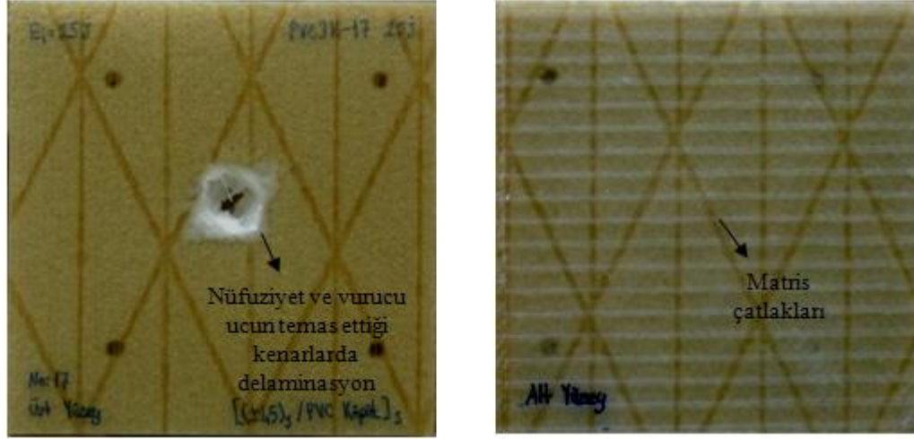
Şekil 5.5 [(\pm 45)_3/\text{PVC Köpük}]_3 oryantasyonlu sandviç kompozit numunenin 25 J’de yapılmış darbe deneyi sonrası üst ve arka yüzeylerinden fotoğrafları
