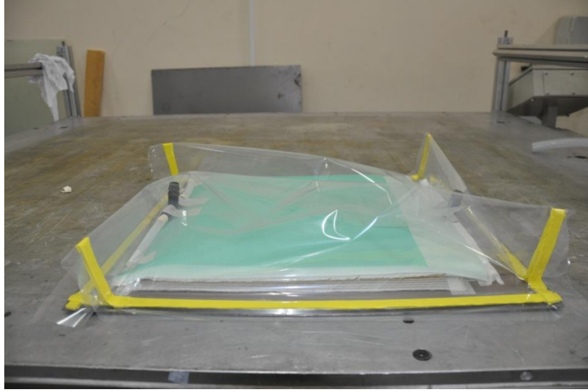
Şekil 4.9 Vakum torbasına alınmış üretilecek tabaka.
