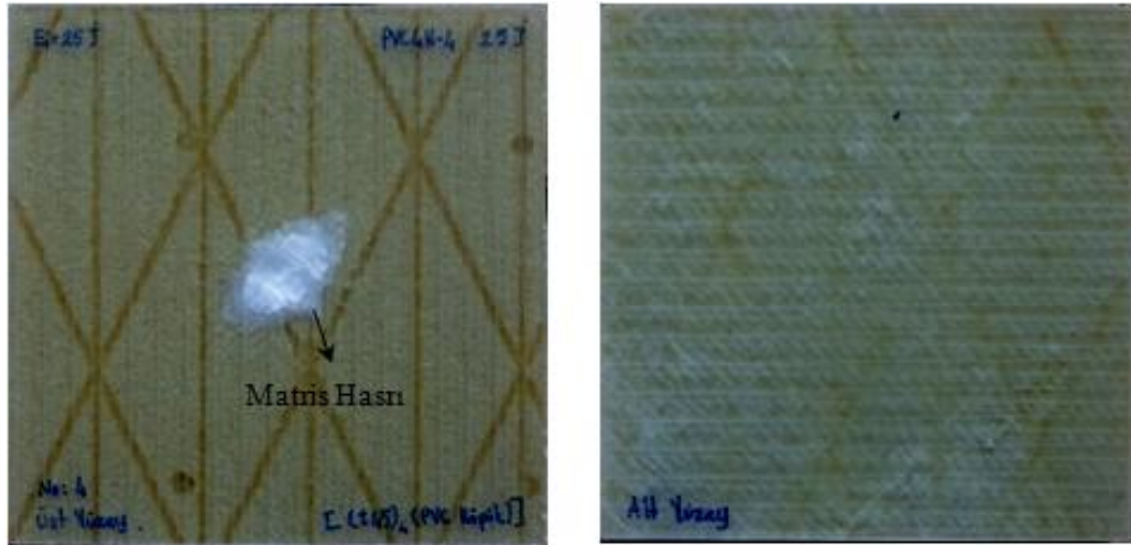
Şekil 5.27 [(\pm 45)_4/\text{PVC Köpük}]_s oryantasyonlu sandviç kompozit numunenin 25 J’de yapılmış darbe deneyi sonrası üst ve arka yüzeylerinden fotoğrafları
