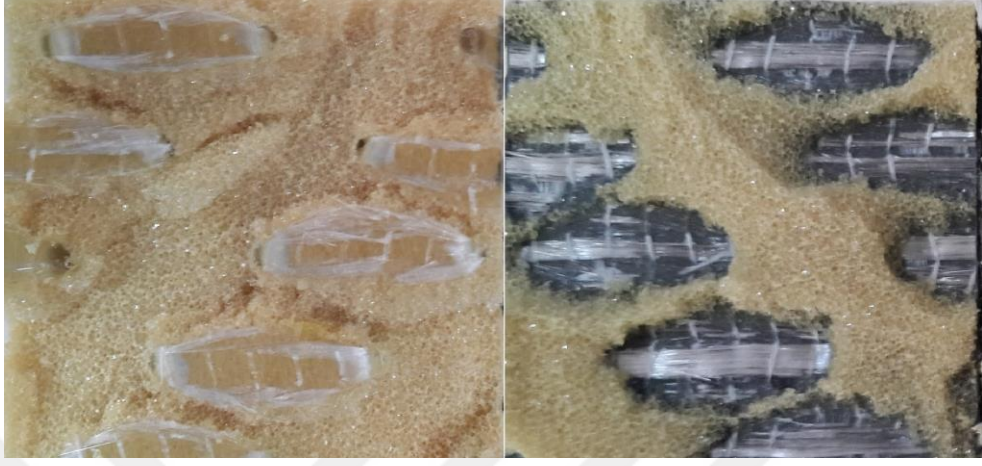
Şekil 4.38 2SCD numunesinde çekirdek-kabuk ayrılma bölgesi (Kişisel arşiv, 2016)
