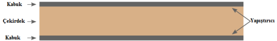
Şekil 1.1 Sandviç malzeme şematik görünümü (Guideline to Core and Sandwich, 2018)
