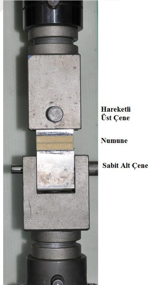
Şekil 2.6 Sandviç kompozit çekme aparatı ve test düzeneği (Alpyıldız, 2016)
