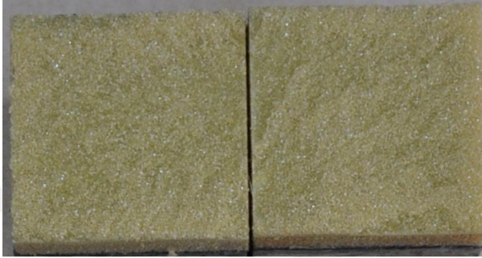
Şekil 4.36 2S numunesinde çekirdek-kabuk ayrılma bölgesi (Kişisel arşiv, 2016)
