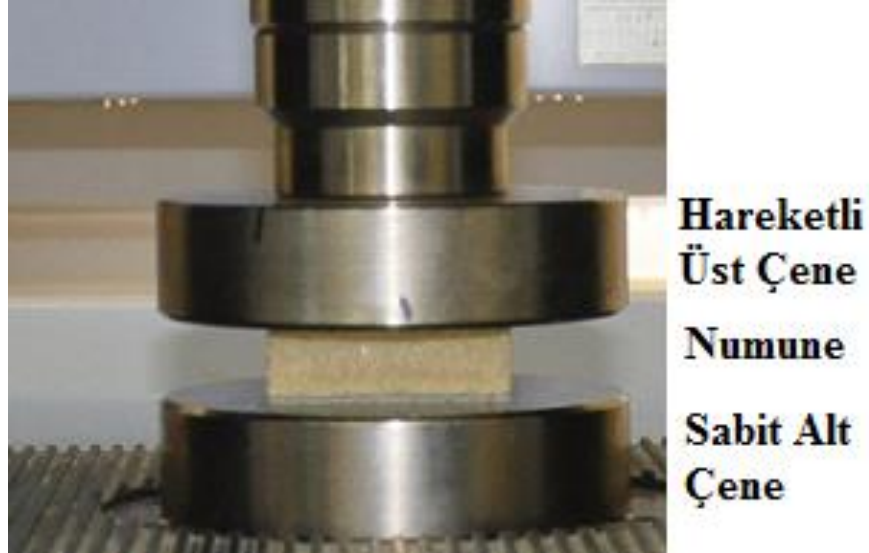
Şekil 2.5 Basma aparatı, test düzeneği ve numune (Kişisel arşiv, 2018)
