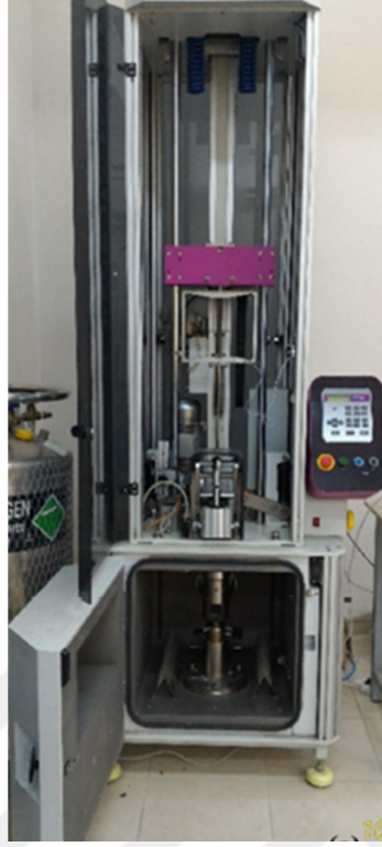
Şekil 3.5 CEAST Fractovis Plus marka darbe cihazı (Kişisel arşiv, 2020)
