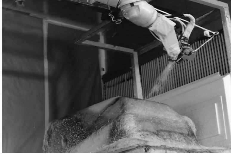
Şekil 2.17 Kırpılmış cam fiber ile üretim (Mazumdar, 2002)
