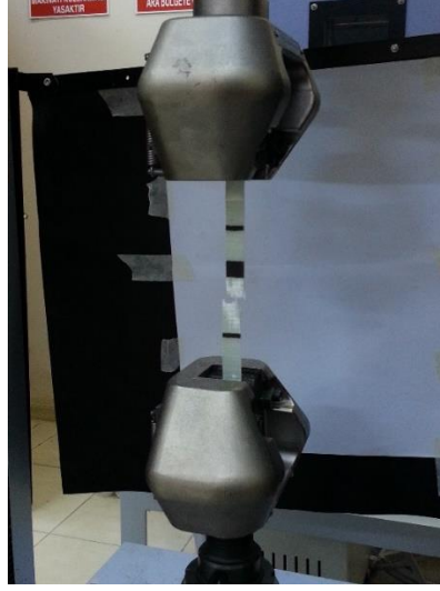
Şekil 2.4 Test sonrası hasarlı numune (Kişisel arşiv, 2016)
