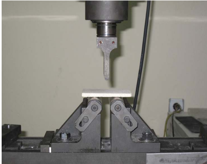
Şekil 5.11 Üç nokta eğme deneyi
