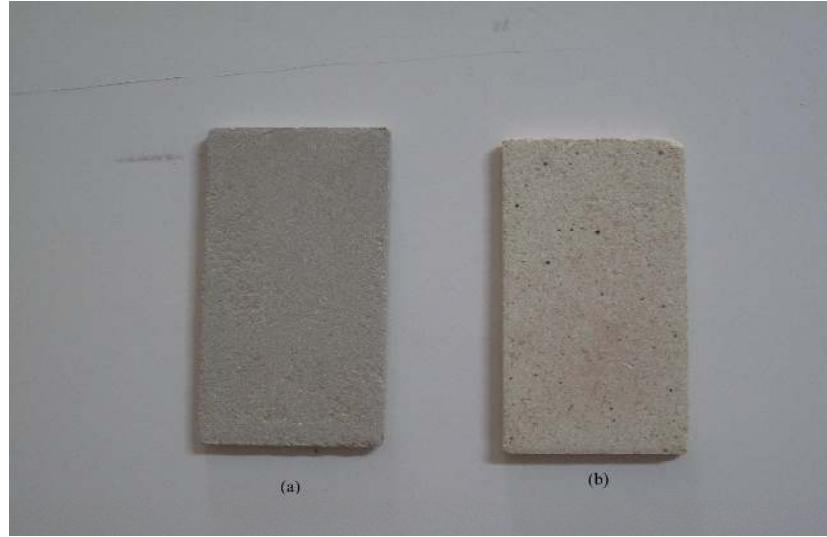
Şekil 5.10 (a) Preslenmiş ve kurutulmuş K2-b numunesi (b) Sinterlenmiş K2-b numunesi
