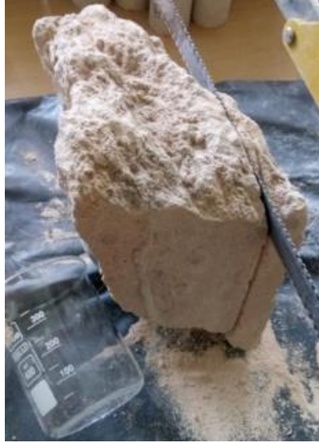
Şekil 13. Testere ile blokların dilimlere ayrılması
