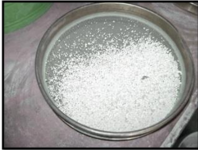
Şekil 18. 10 no'lu elekten geçen numuneler
