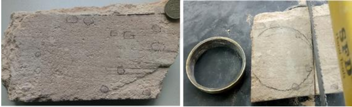
Şekil 15. Numunenin plakaya göre kesilmesi
