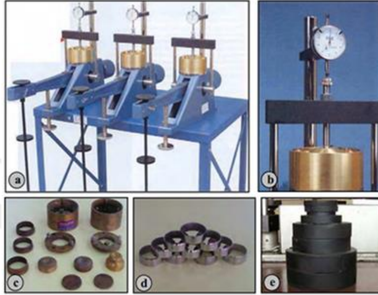
Şekil 11. Konsolidasyon deney düzeneği, ödometre cihazının genel görüntüsü (a), konsolidasyon hücresi (b), hücre içi aparatlar, numune ringleri(c), yükleme plakaları (d)
