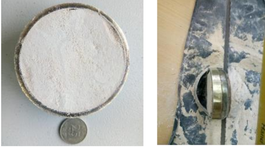
Şekil 17. Halka plakadaki iki yüzeyin düzeltilmesi
