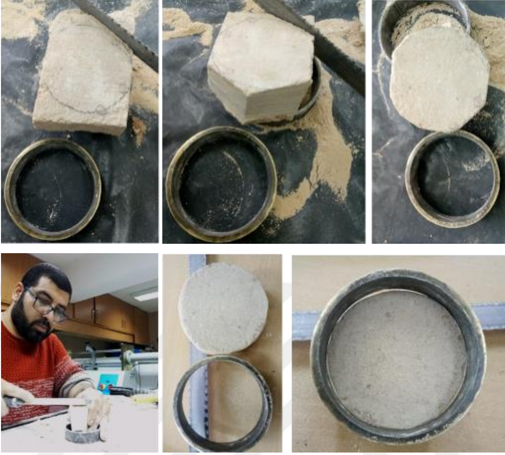
Şekil 16. Numunenin plakaya yerleştirilmesi
