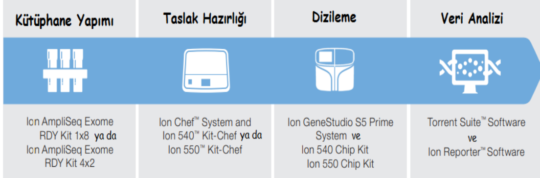
Şekil 41; Ion AmpliSeq™ Exome RDY kit ile ekzom dizileme basamaklarının şematik gösterimi ( http://assets.thermofisher.com/TFS-Assets/CSD/Flyers/ion-ampliseq-exome-rdy-flyer.pdf )
