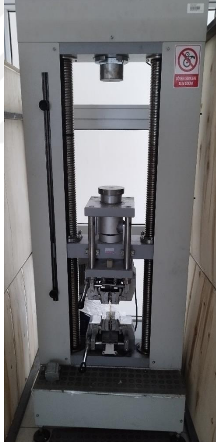
Şekil 4.20. Mares Tst-10t çekme makinesi Ondokuz Mayıs Üniversitesi Laboratuvarı
