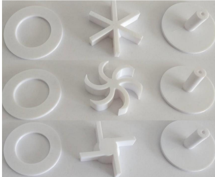
Şekil 4.21. 3 parça halinde üretilen çark
