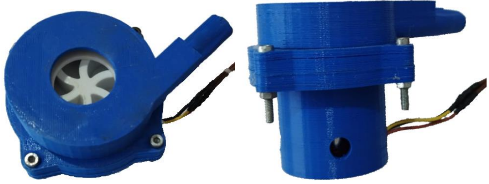
Şekil 5.15. 3D Baskı Üretimi Santrifüj Pompa
