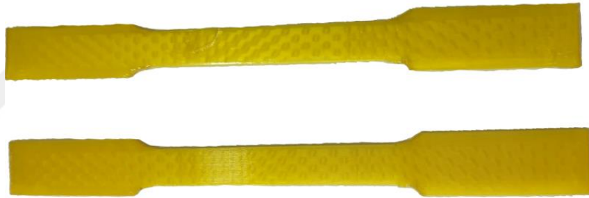
Şekil 5.12. Çekme testi numuneleri
