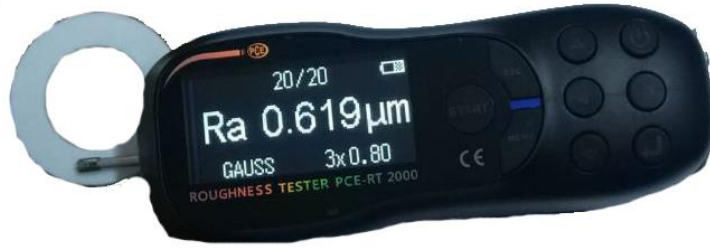
Şekil 5.9. Yüzey pürüzlülük ölçümü
