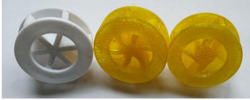
Şekil 4.22. Birleştirilmiş pompa çarkları
