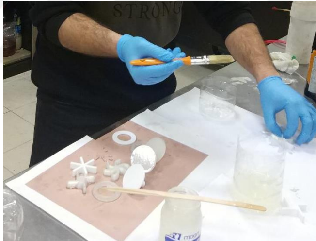
Şekil 4.16. Numunelere katkılı epoksi uygulanması
