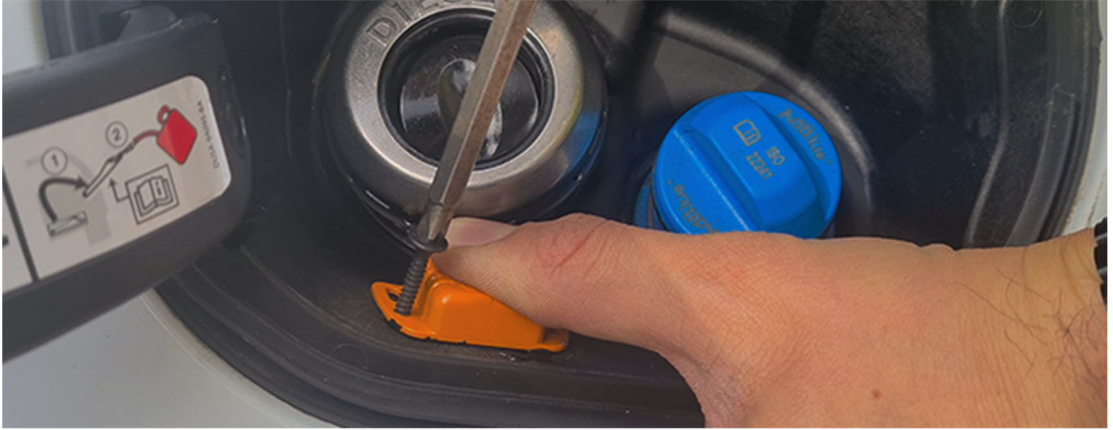
Şekil 8. Taşıt Tanıma Birimi (TTB) Montajı Gösterimi
